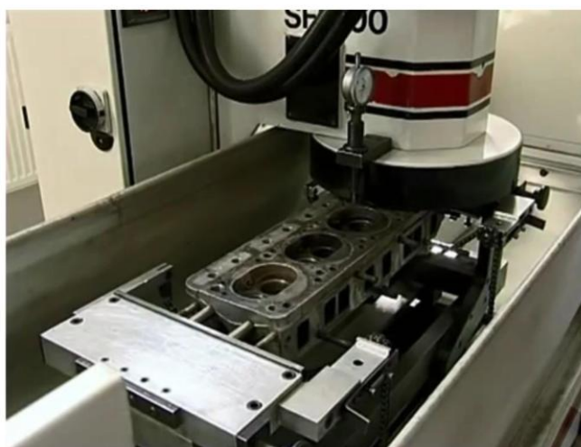
Рисунок 1.7 - Шлифовка привалочной плоскости головки блока цилиндров
