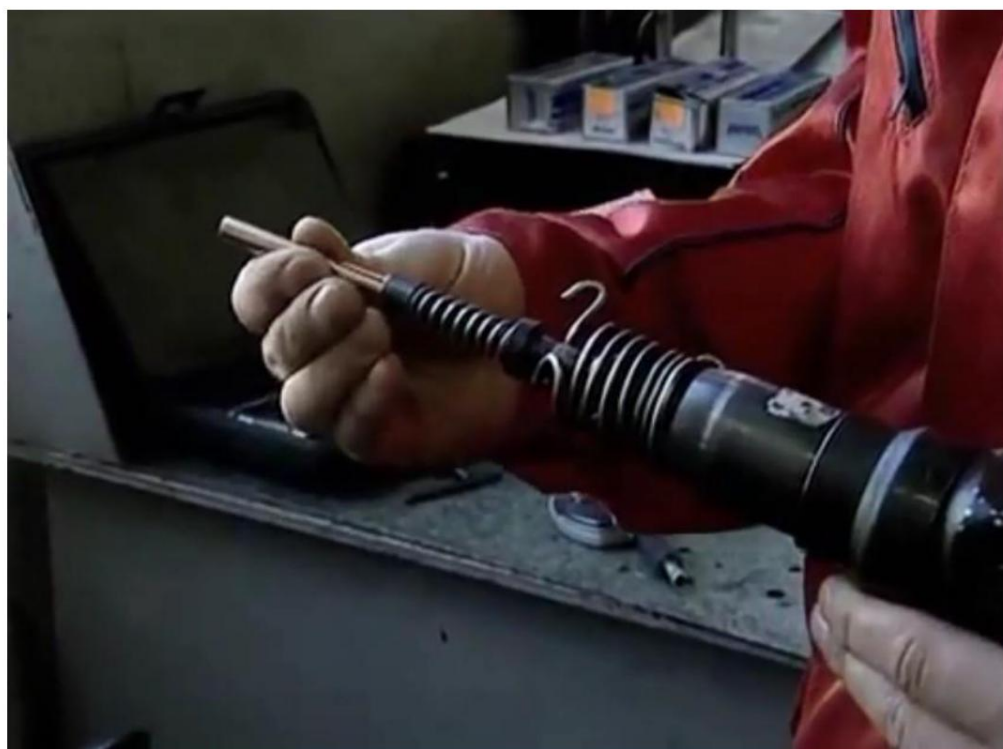
Рисунок 1.5 - Восстановление направляющей втулки клапана
