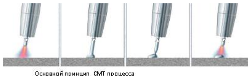
Рисунок 2.2 – Основной принцип сварки короткими замыканиями
