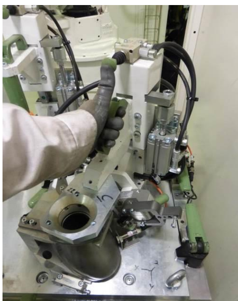
Рисунок 1.11 – Сварка конуса с втулкой и выпускным фланцем
