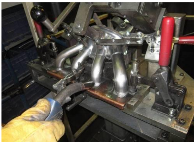
Рисунок 2.10 – Положение сварочной горелки для прихваток фланца
