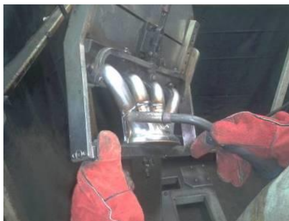
Рисунок 2.13 – Сварка верхнего узла
