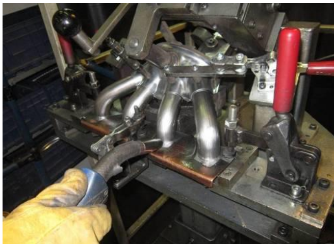
Рисунок 1.12 – Положение сварочной горелки для прихваток фланца
