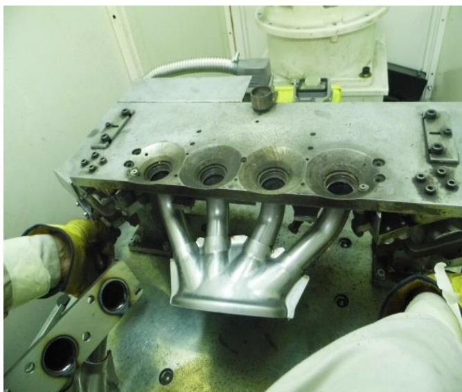
Рисунок 2.12 – Сварка трубок к фланцу
