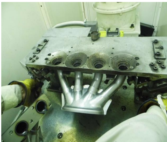
Рисунок 1.14 – Сварка трубок к фланцу
