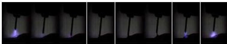
Рисунок 2.3 - Последовательность действий в цикле СМТ сварки.
