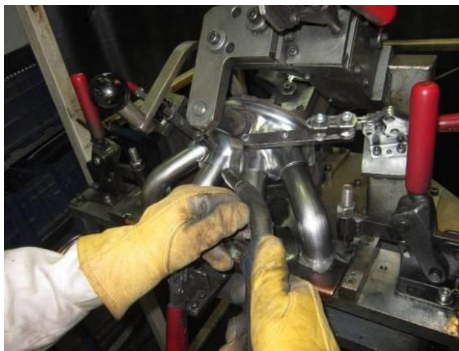
Рисунок 1.13 – Положение сварочной горелки для прихваток полукорпуса
