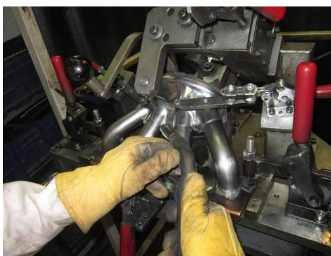
Рисунок 2.11 – Положение сварочной горелки для прихваток полукорпуса
