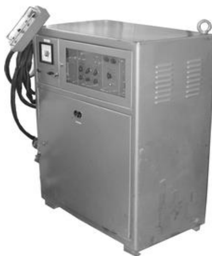
Рис 3.3 – Внешний вид источника питания ИСВУ-100У2
