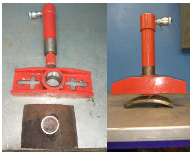
Рисунок 2.14 - Изготовленная опора из сегмента трубы
