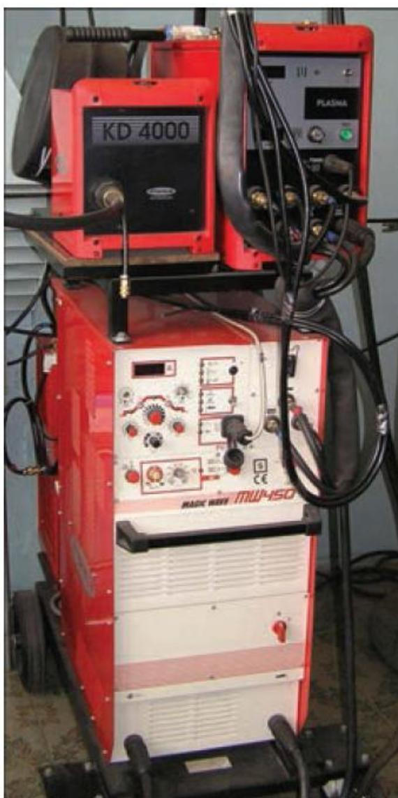
Рисунок 2.5 - Оборудование фирмы «Fronius» для плазменно–дуговой сварки алюминиевых сплавов разнополярным асимметричным током
