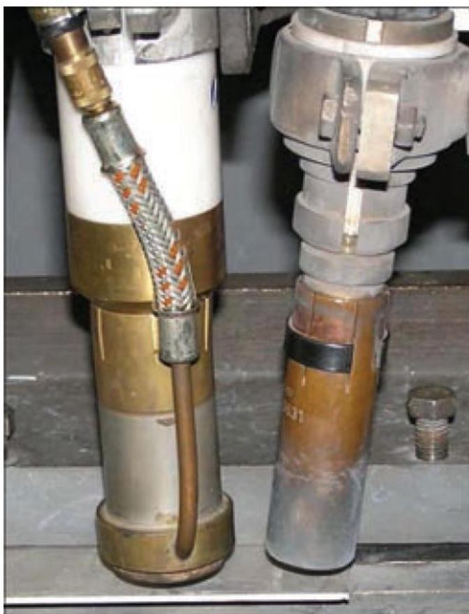
Рисунок 1.3 - Размещение плазматрона и горелки плавящегося
