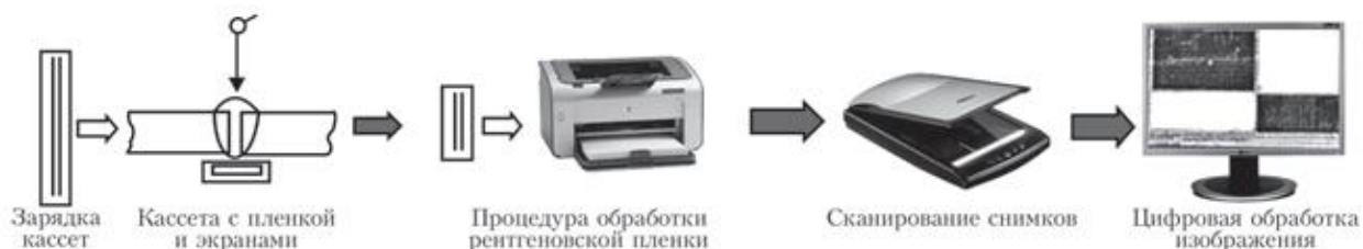
Рисунок 2.1 – Традиционная схема радиографического контроля с использованием пленки и оцифровки рентгенограмм
