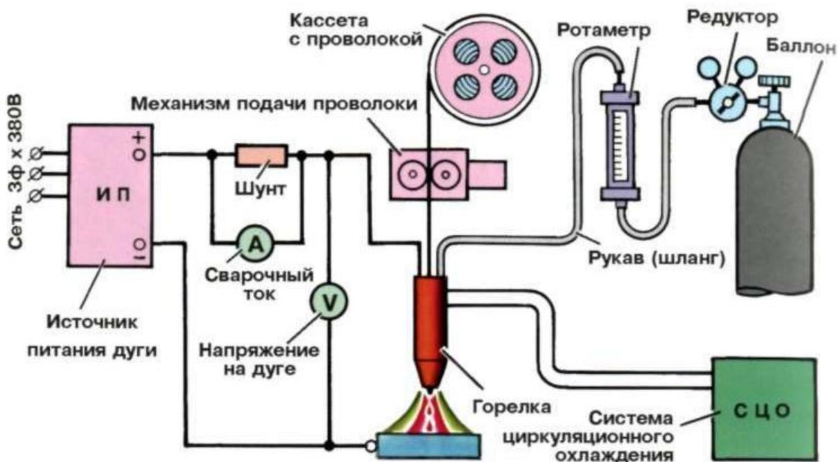
Рисунок 2.3 – Установка для дуговой наплавки в углекислом газе
