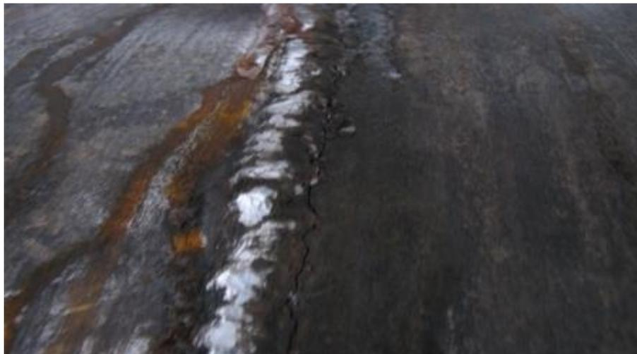
Рисунок 1.5 - Трещина в месте ремонтной сварки
