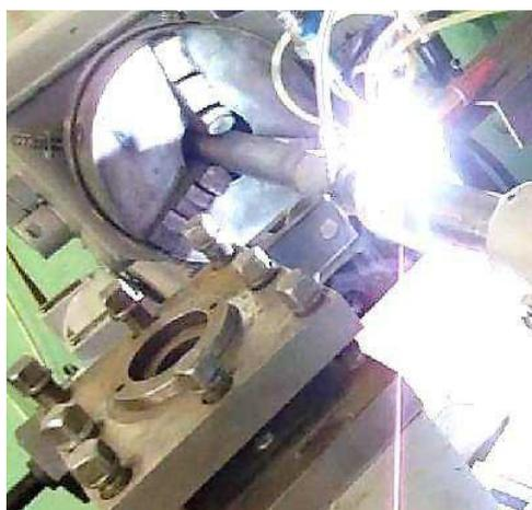
Рисунок 2.7 – Внешний вид оборудования для плазменной наплавки деталей вращения
