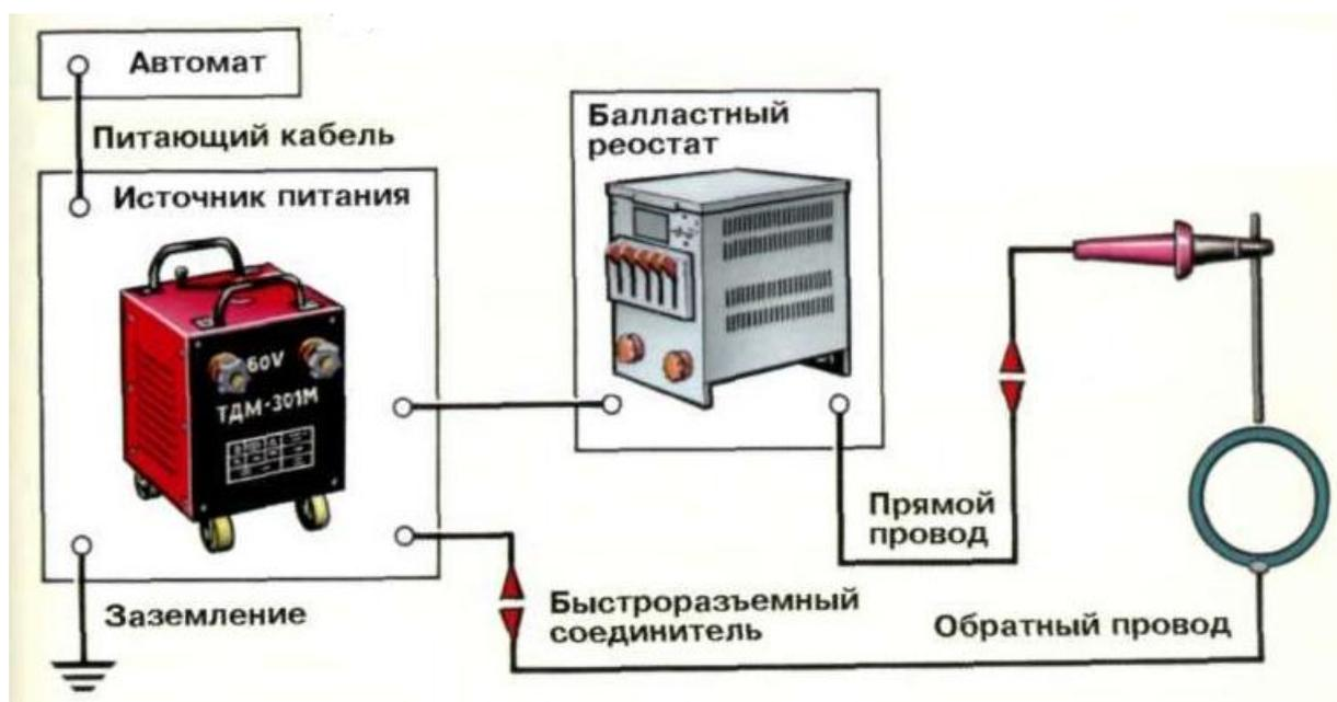
Рисунок 2.1 – Процесс дуговой наплавки штучными электродами
