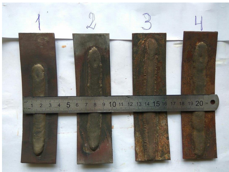
1 – образец без флюса; 2 – образец с флюсом №1; 3 – образец с флюсом №2; 4 – образец с флюсом №3 Рисунок 3.1 – образцы наплавки для выбора флюсов
