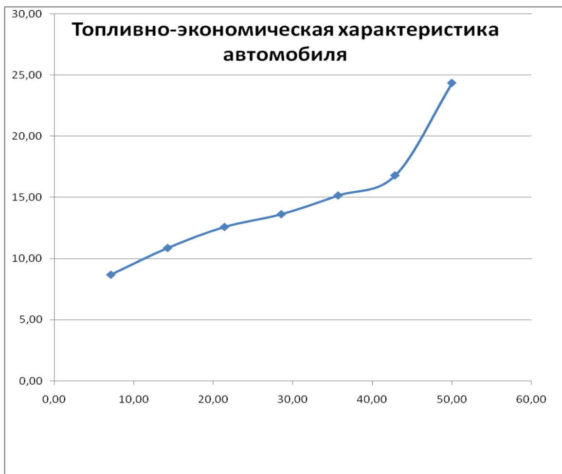
Рисунок 2.10 – Топливоно-экономическая характеристика автомобиля
