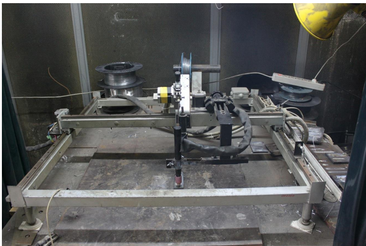
Рисунок 2.1 – Установка для автоматической аргодуговой наплавки неплавящимся электродом с подачей присадочной проволоки
