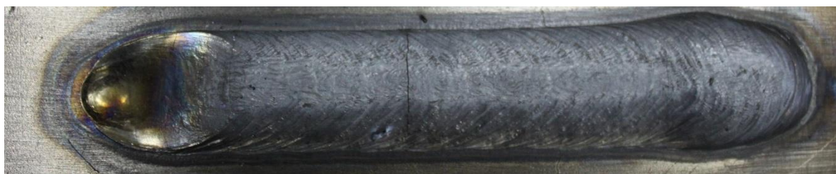
Рисунок 3.8 - Внешний вид наплавленного образца №2
