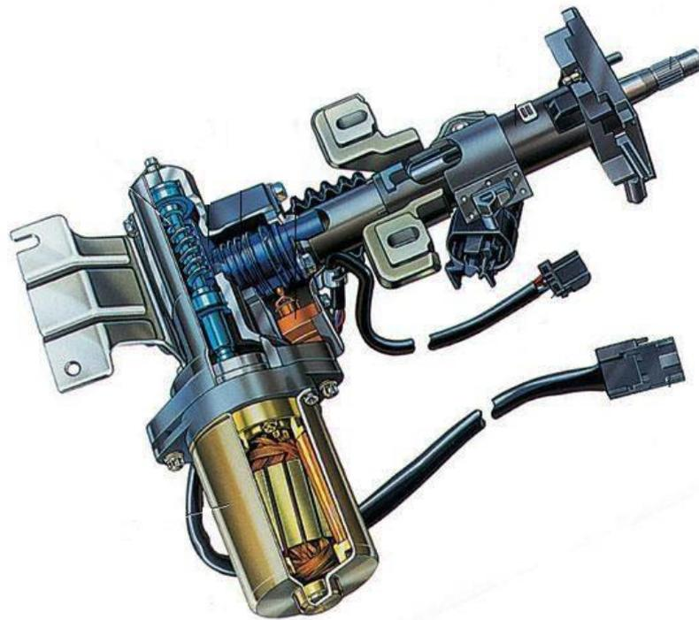
Рисунок 1.4- Электрический усилитель, расположенный на рулевой колонке
