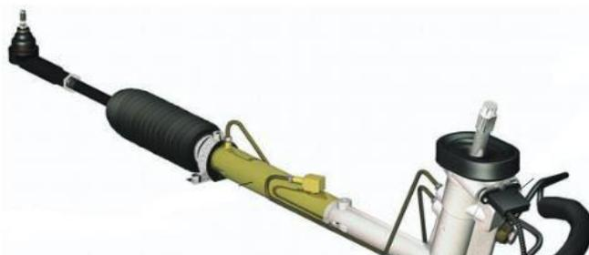
Рисунок 1.5 - Электрогидравлический усилитель
