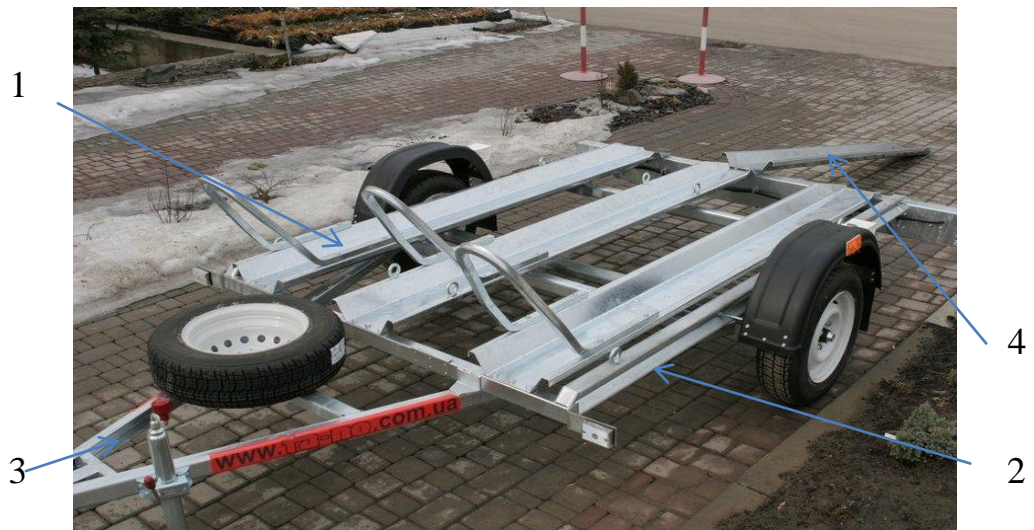
1 – погрузочные платформы, 2 - основание, 3 – буксирное устройство, 4 – направляющая колес
