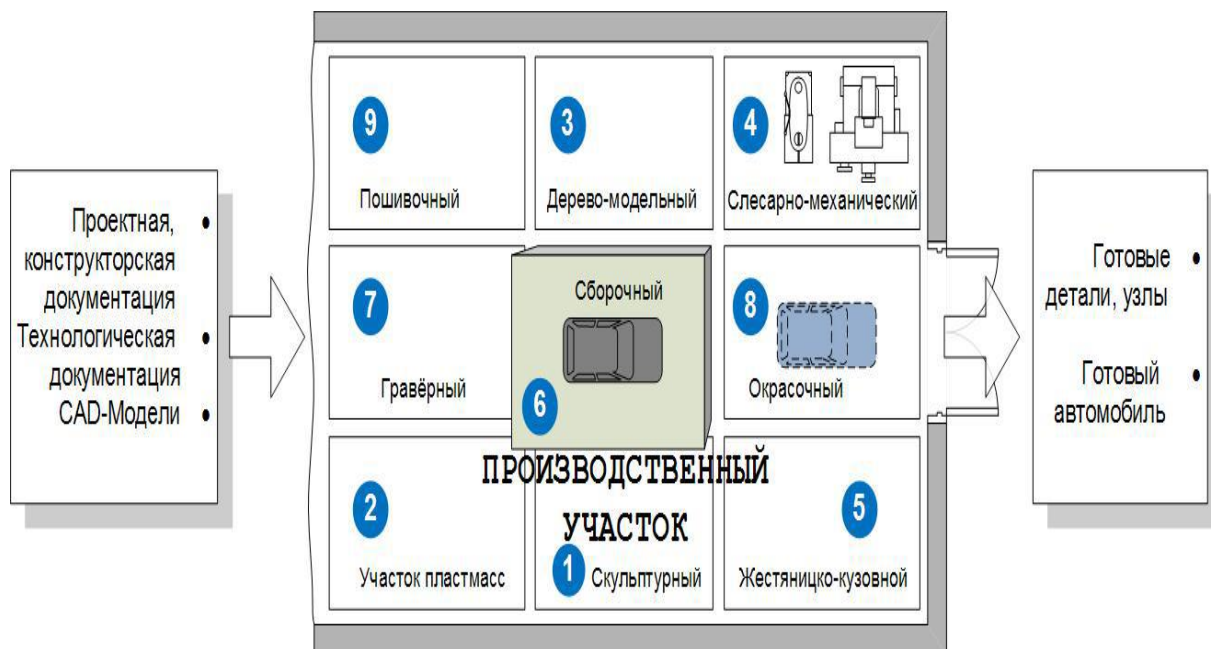
Рисунок 1.8 – Схема связей отделений производственного участка FS
