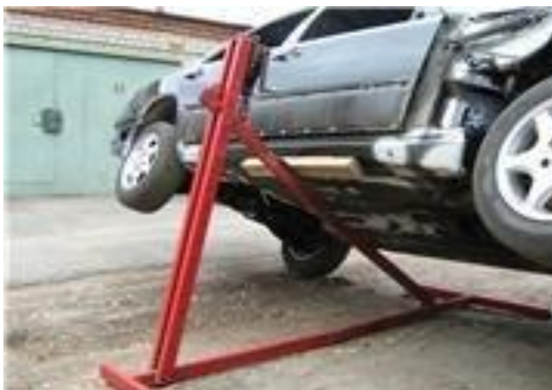
Рисунок 3.6 – Рабочее положение автомобиля на подъемнике УМС-2
