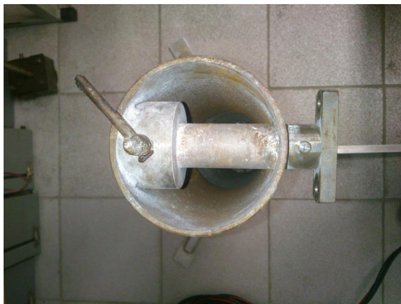
Рисунок 12- Механизм для крепления приспособления к телескопической стойке
