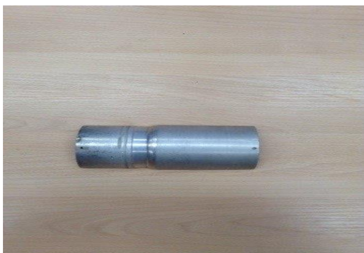
Рисунок 6 – Фрагменты оболочек тепловыделяющих элементов из разнородных сплавов
