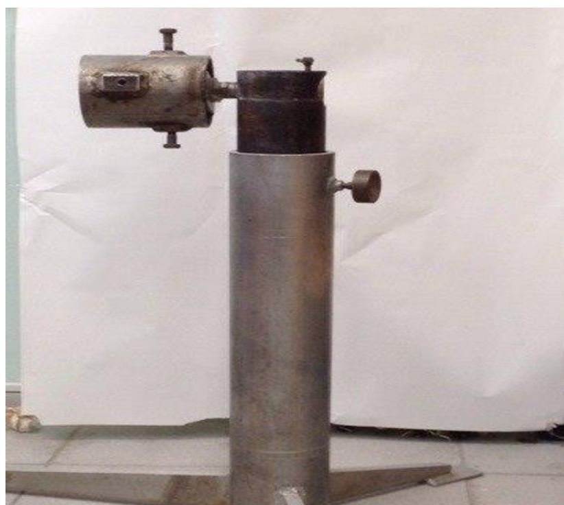
Рисунок 14 – Телескопическая стойка в сборе с приспособлением для крепления трубы
