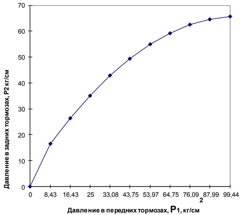
Рисунок 2.2 – Хар-ка регулятора давления задних тормозов(с част. нагр.)
