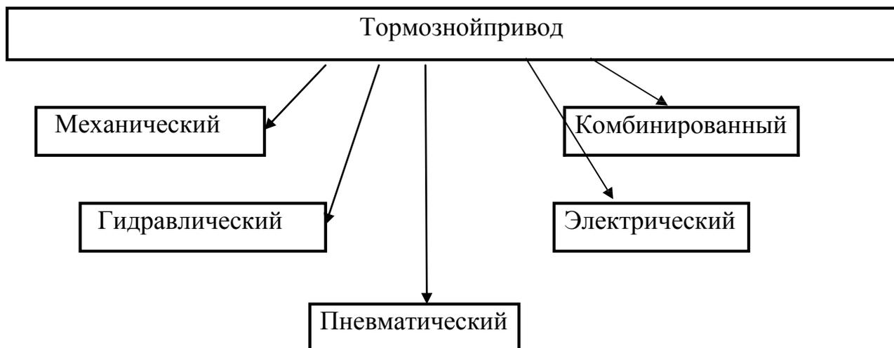
Рисунок 1.2 - Классификация тормозных приводов
