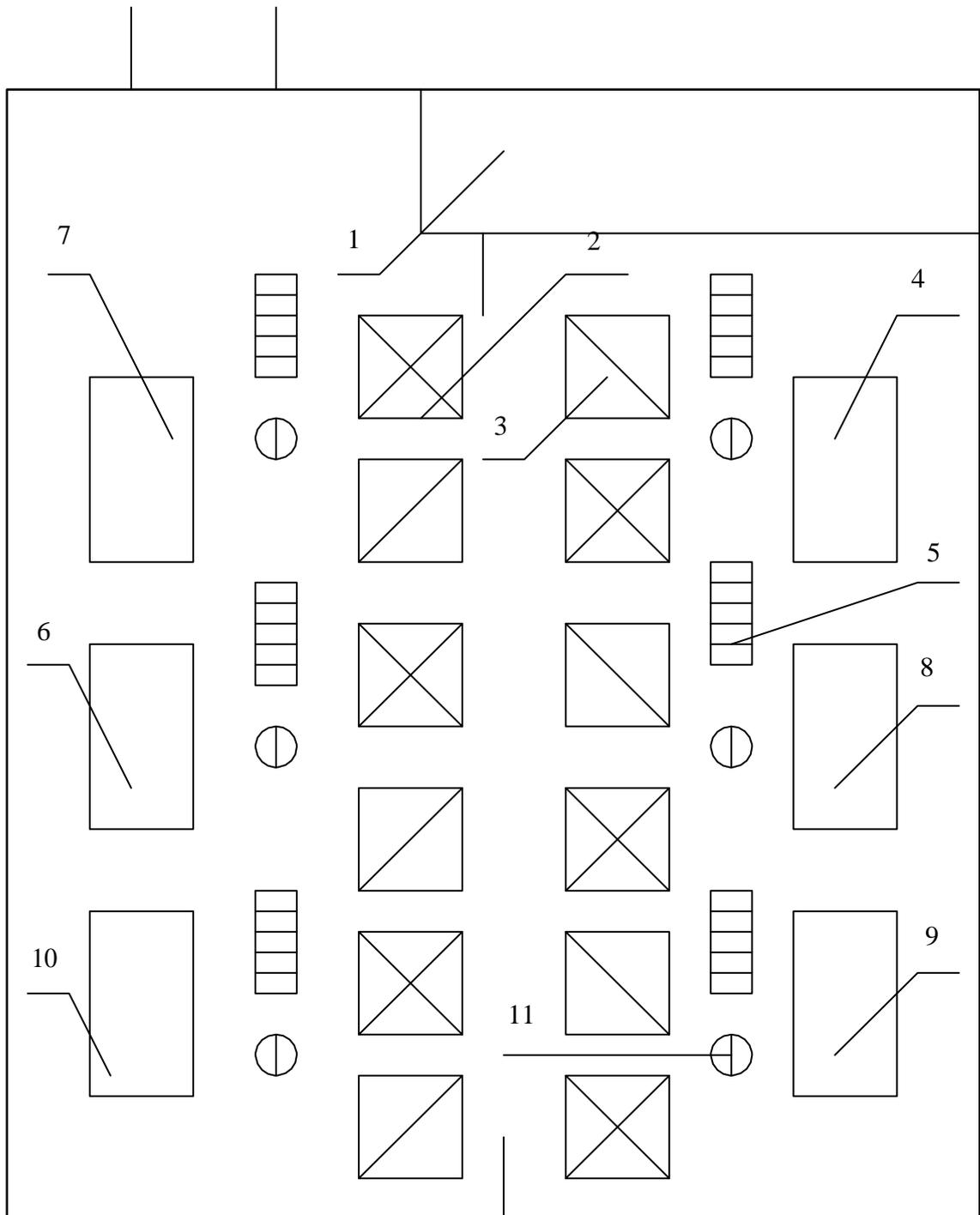
1-место для отдыха; 2-сверлильный станок; 3-пресс; 4-контрольный стенд;
