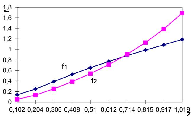
Рисунок 2.7 – Распределение коэф ффициента сцепления по осям (частичн. нагр.)
