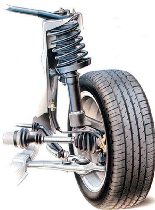
Рисунок 4 – Вариант исполнения подвески МакФерсон
