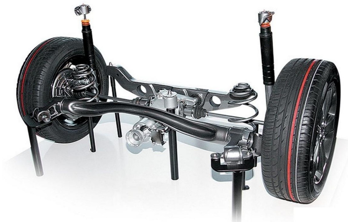
Рисунок 9 – Полузависимая задняя подвеска
