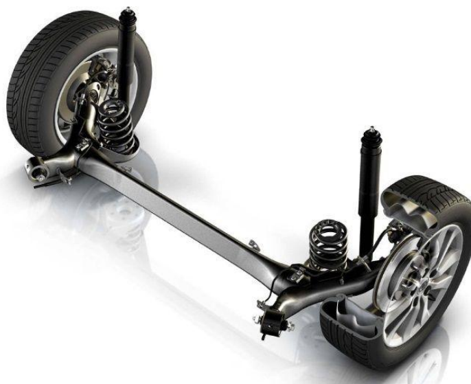
Рисунок 2 – Вариант исполнения полузависимой подвески
