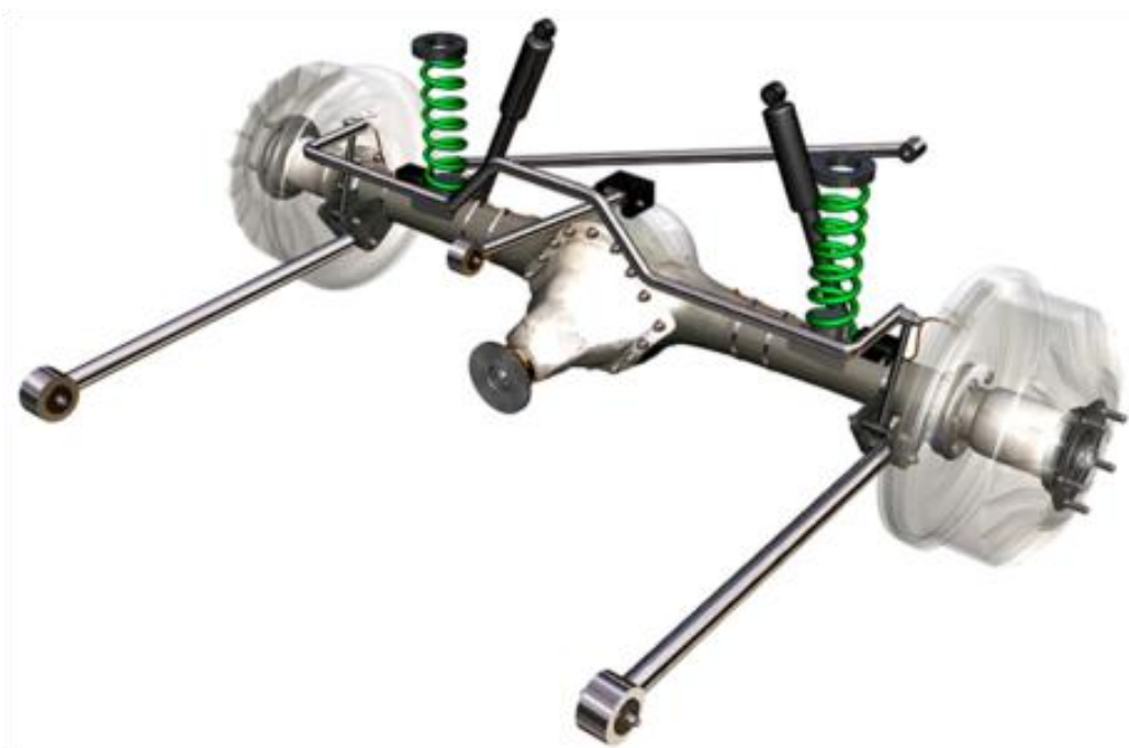
Рисунок 6 – Зависимая подвеска с тягой Панара
