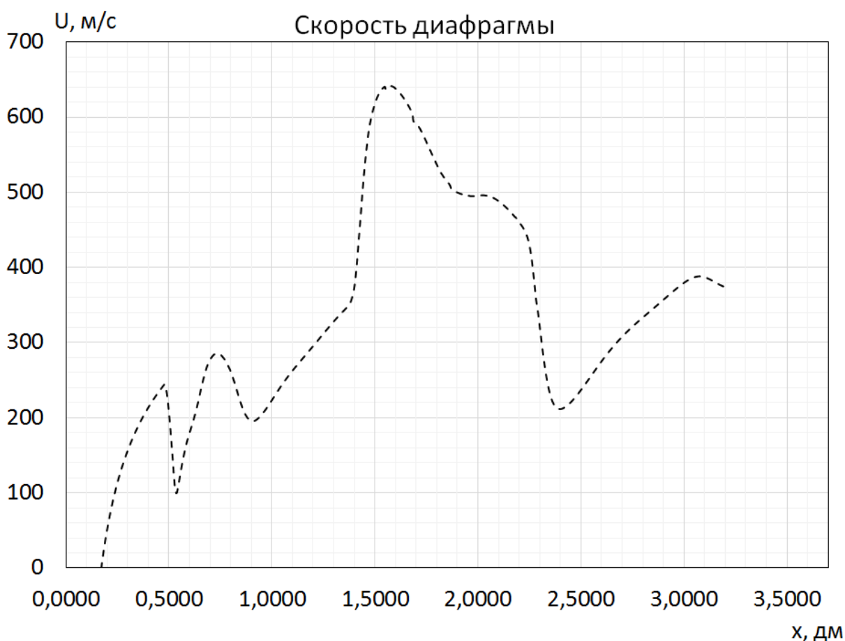
Рисунок 17 – Баллистическая система ВПО-208. Зависимость скорости диафрагмы от координаты по результатам работы компьютерной модели.
