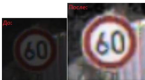
Рисунок 17 – Результат работы модуля предподготовки изображений
