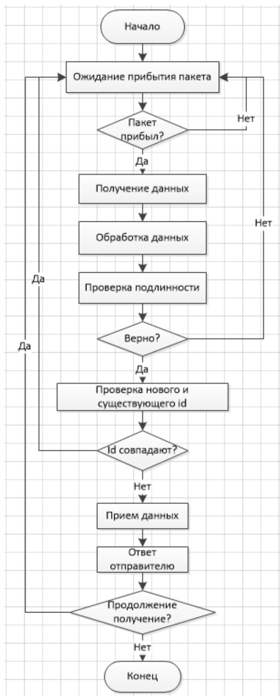
Рисунок 3.10 – Алгоритм получения, обеспечивающий целостность при взаимодействии агентов
