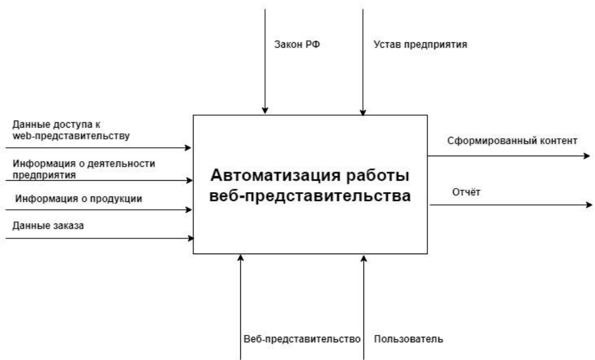
Рис 1.5. Контекстная диаграмма процесса «Автоматизация работы веб-представительства», модель «КАК ДОЛЖНО БЫТЬ». Уровень 0 (методология IDEF0)
