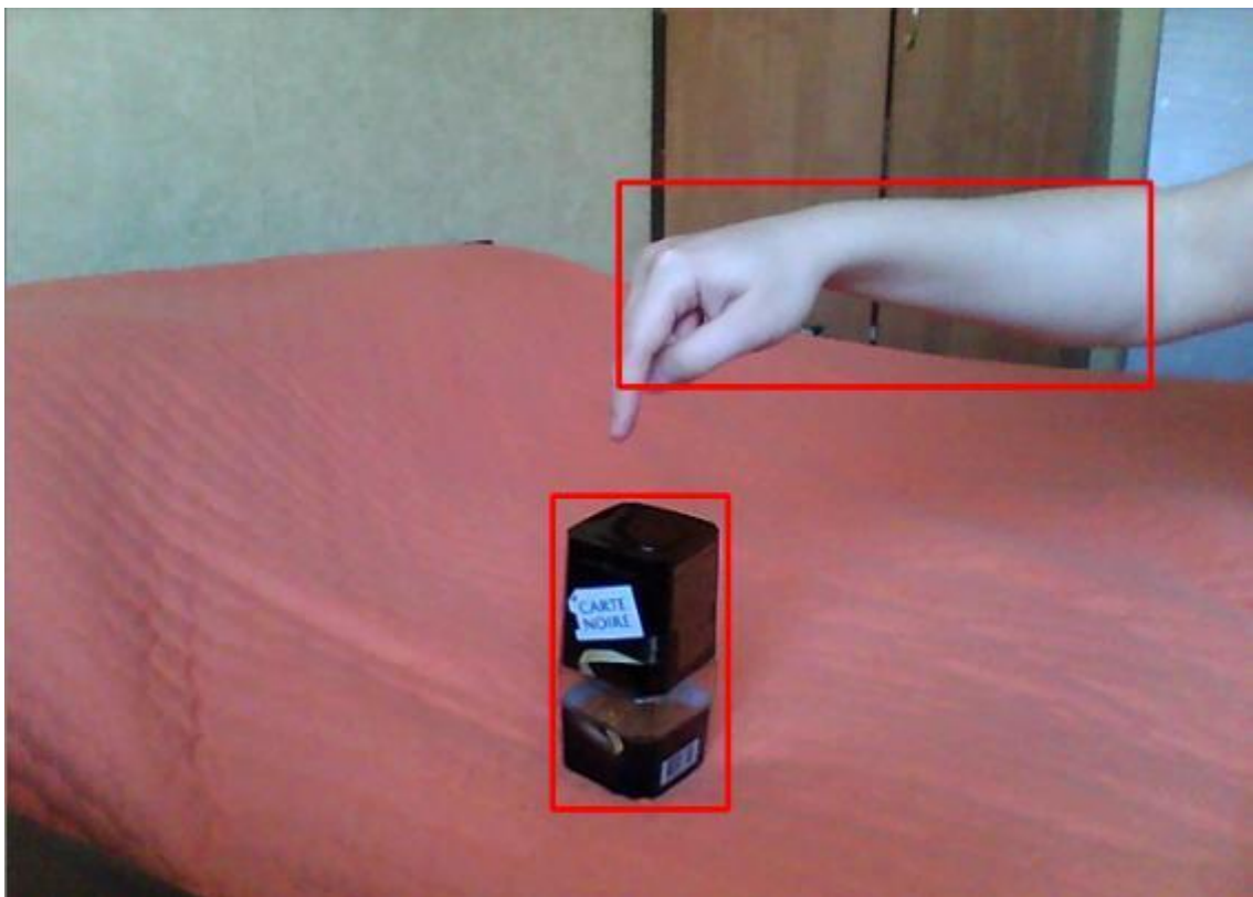
Рисунок 3.2 – Применение алгоритма при локализации покоящегося объекта, находившегося до этого в движении (банка кофе): а – в движении, б – в состоянии покоя
