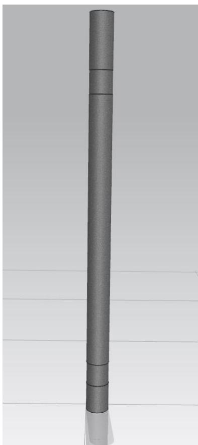
Рисунок 5.1.1 Модель стяжного болта.
