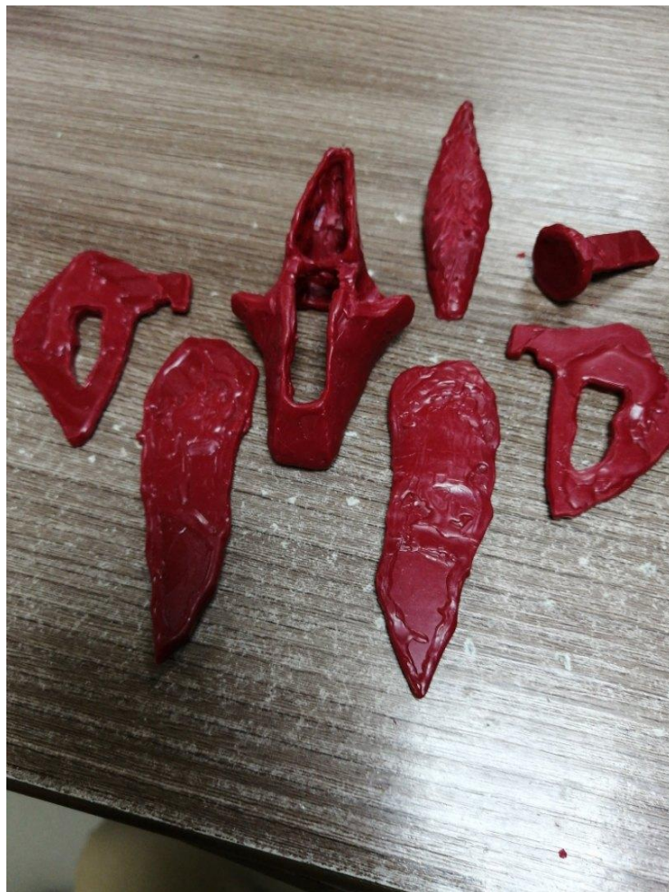
Рисунок 13. Изготовление восковой формы после внесения поправок.
