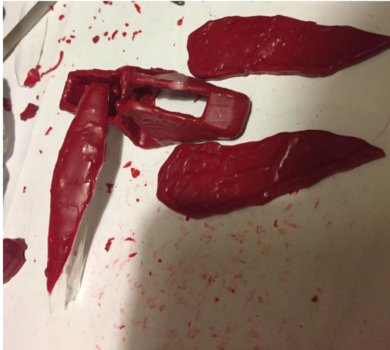
Рисунок 12. Изготовление восковой формы, начало.
