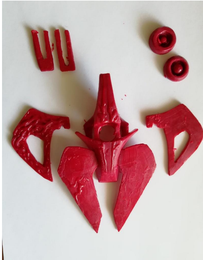
Рисунок 14. Изготовление восковой формы, подгонка и выравнивание формы.
