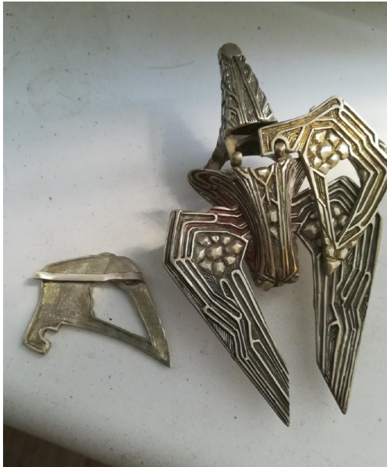
Рисунок 25. Подготовленные элементы крепления и пайка достающих элементов к основанию.
