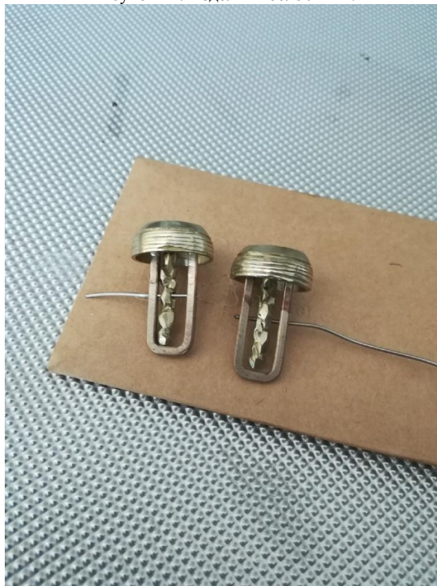
Рисунок 23. Подготовка запонки к пайке.
