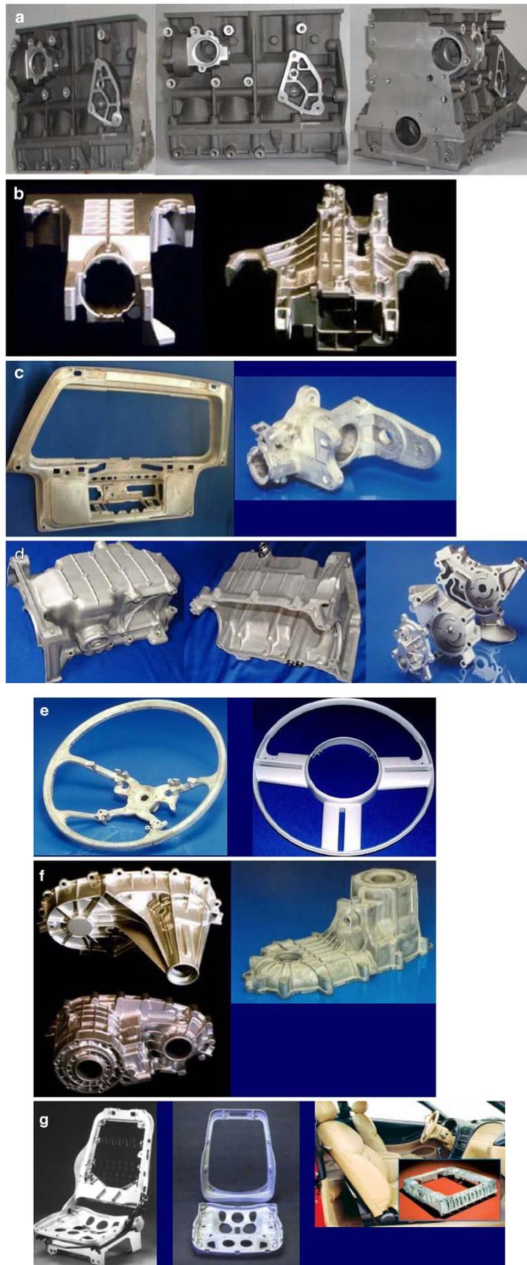
Рисунок 4 – Использование магния в автомобиле
