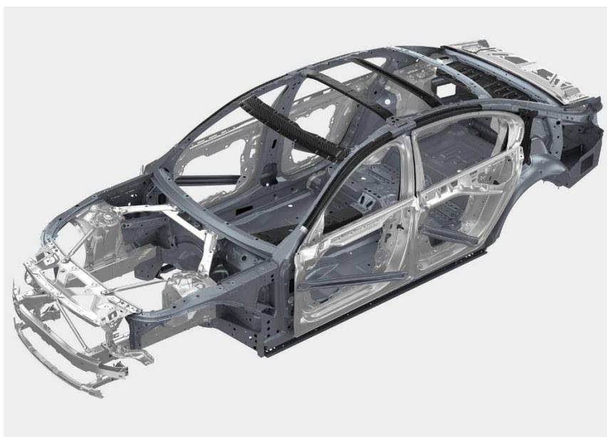
Рисунок 2 – Кузов BMW 7-серии G-12, построенный по принципу «Карбоновое ядро»
