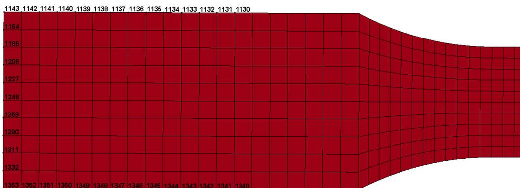
Рисунок 27 - Узлы, для которых заданы ограничения движения
