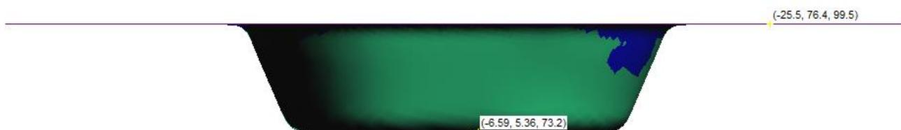
Рисунок 46 – Предельная глубина вытяжки магниевго сплава AZ31B-O
