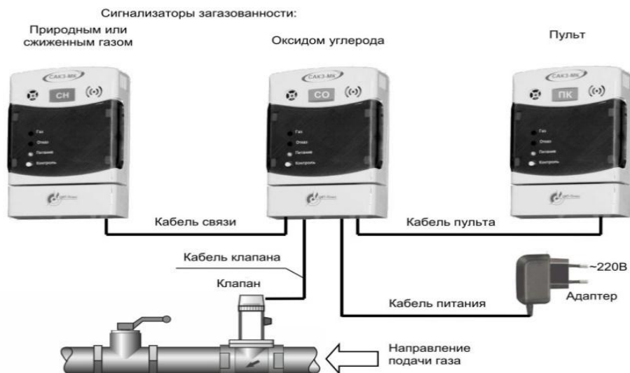
Рисунок 7.1 – Структурная схема установки САКЗ-МК-1-1А.
