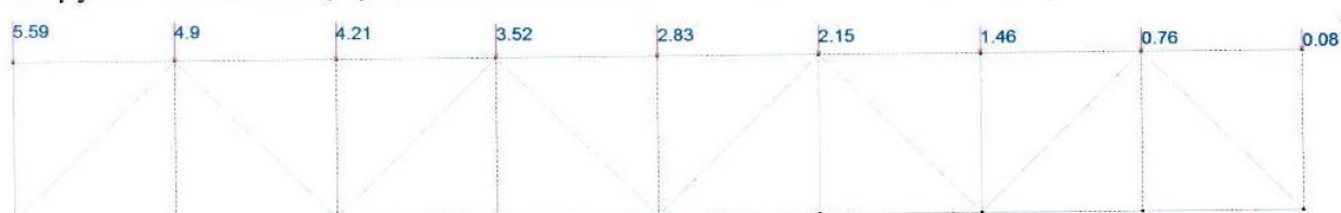
Рисунок 2.4 – Нагрузка – снеговая (с учетом повышенного снегоотложения \mu=5,05 )
