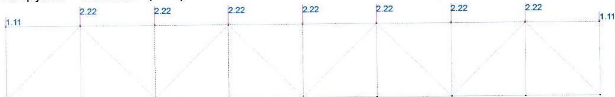
Рисунок 2.5 – Нагрузка – снеговая (без учетом повышенного снегоотложения \mu=1 )
