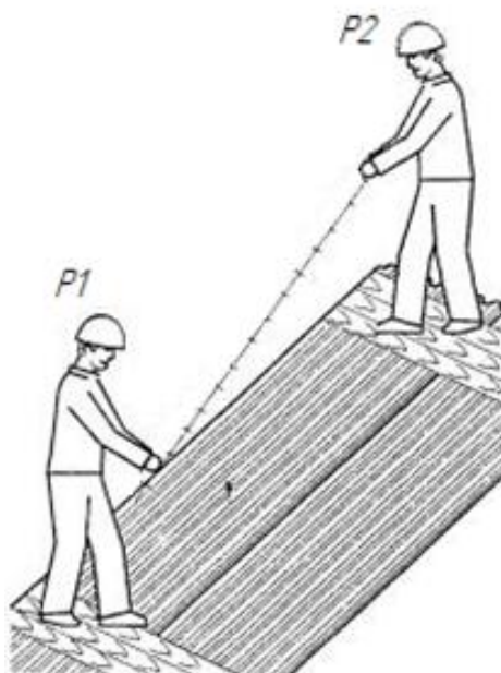
Рисунок 3.2.9 – Раскладка арматурных каркасов
