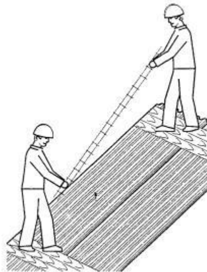
Рисунок 3.8 – Раскладка арматурных каркасов
