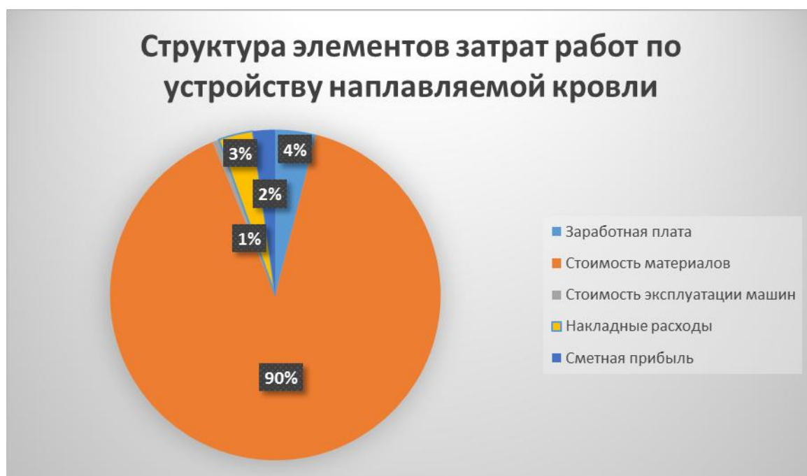
Рисунок 5.1 – Структура элементов затрат работ по устройству наплавленной кровли
