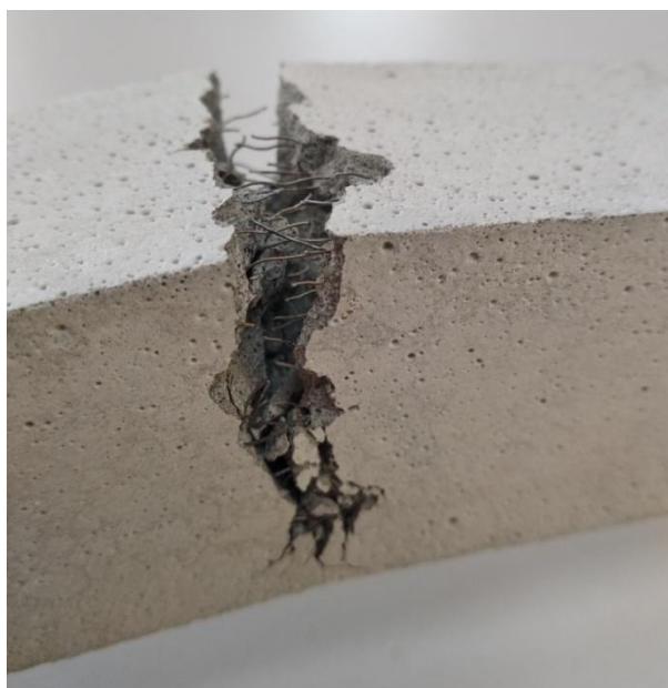
Рисунок 3.7 – Образец – призмы с металлической фиброй после испытания на изгиб
