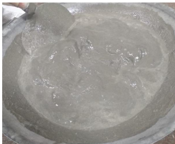
Рисунок 3.14 – Приготовление фибробетонной смеси с полипропиленовой фиброй
