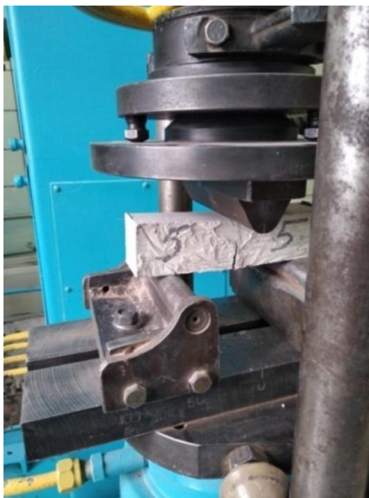
Рисунок 3.4 – Установка для испытания образцов фибробетонной смеси на изгиб
