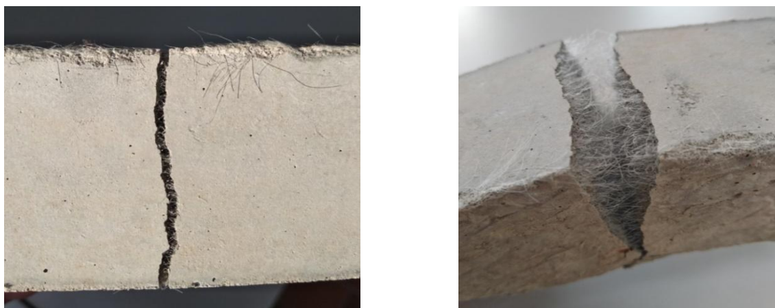
Рисунок 3.19 – Образец партии №2 после испытания на изгиб
