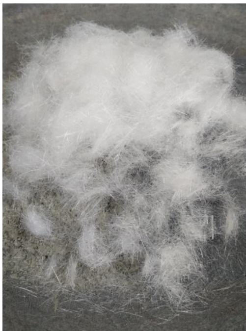
Рисунок 2.3 – Полиамидное волокно (отход производства «КуйбышевАзот»)
