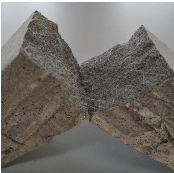
Рисунок 3.27 – Образец партии №12 после испытания на изгиб
