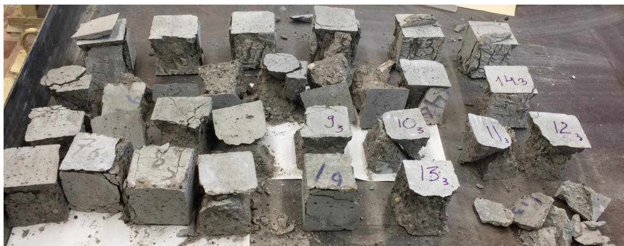
Рисунок 3.25 – Образцы, испытанные на прочность при сжатии
