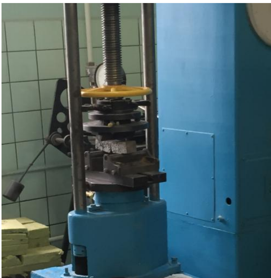
Рисунок 3.18 – Разрушение образца при испытании на изгиб
