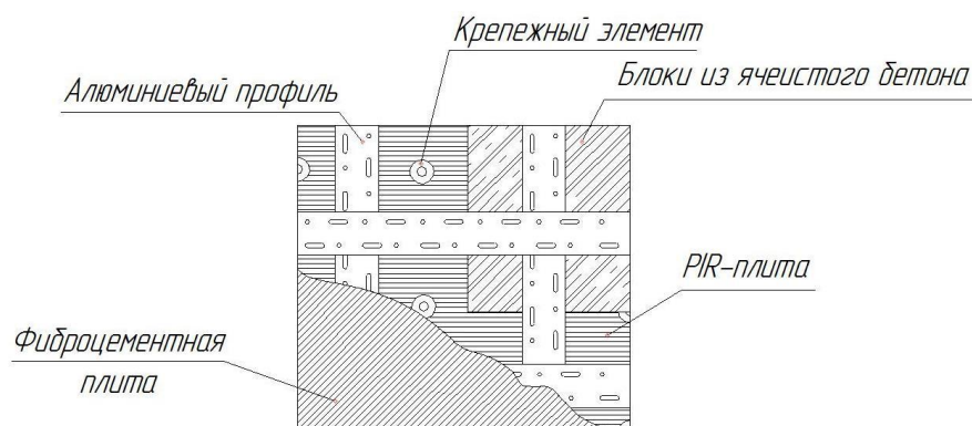
Рисунок 2.16 – PIR – плита, как утеплитель навесного фасада
