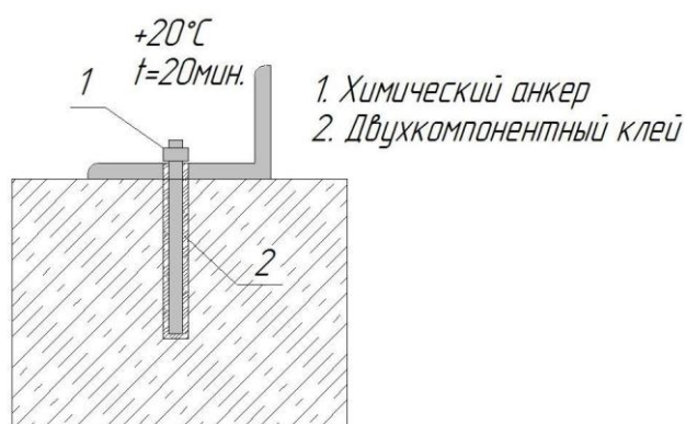
Рисунок 2.10 – Закрепление химического анкера (вид сбоку)
