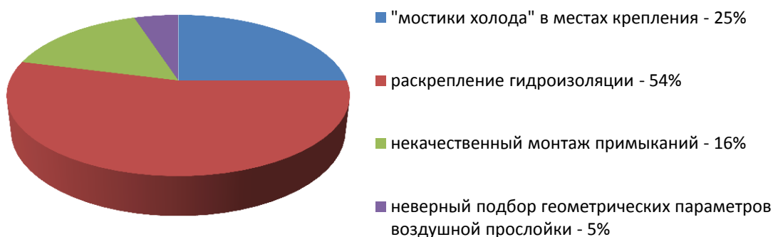
Рисунок 2.13 – Причины снижения теплоизолирующих свойств навесных фасадных систем
