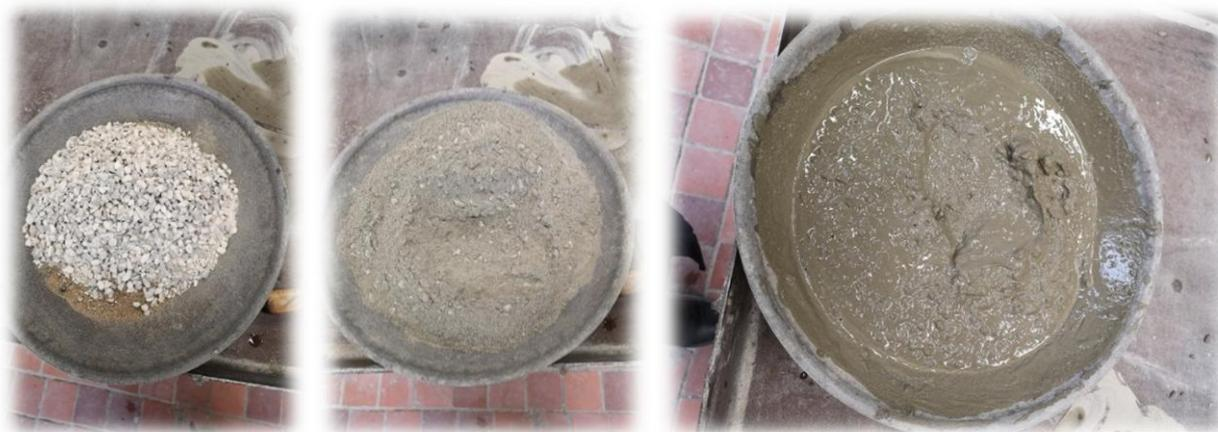
Рисунок 3.4 – Состав бетонной смеси с применением гиперпластификатора STACHEMENT
