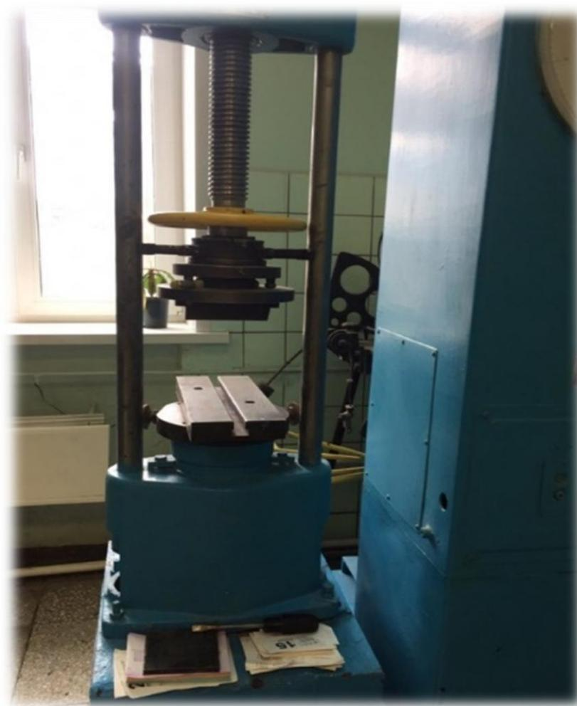
Рисунок 3.7 – Установка для испытания образцов на изгиб
