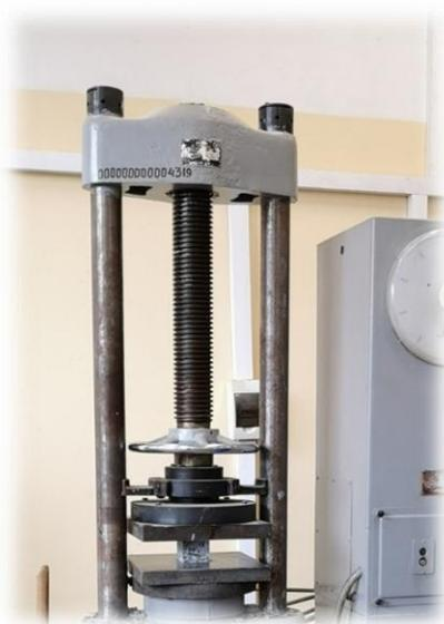
Рисунок 2.1 – Пресс для проведения испытаний на сжатие
