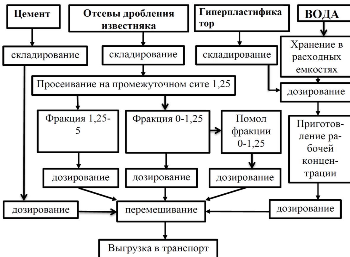
Рисунок 1.4 – Применение отсевов дробления карбонатных пород [62]
