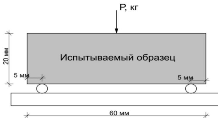
Рисунок 3.6 – Схема испытания образцов на изгиб
