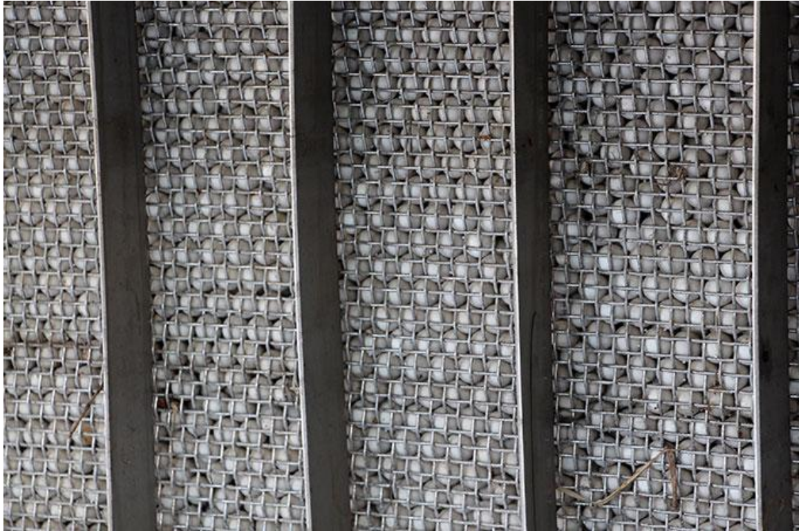
Рисунок 3.3 – Фильтрующая кассета, заполненная пороэластовыми шариками
