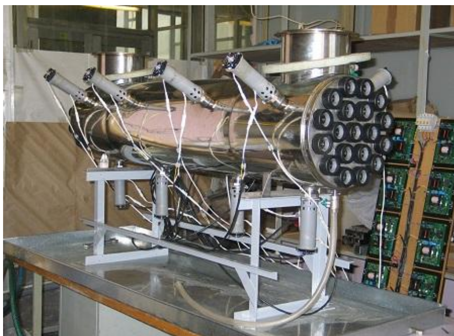
Рисунок 2.17 – Установка для обеззараживания воды комбинированным воздействием ультразвука и ультрафиолетового облучения «Лазурь М 250»
