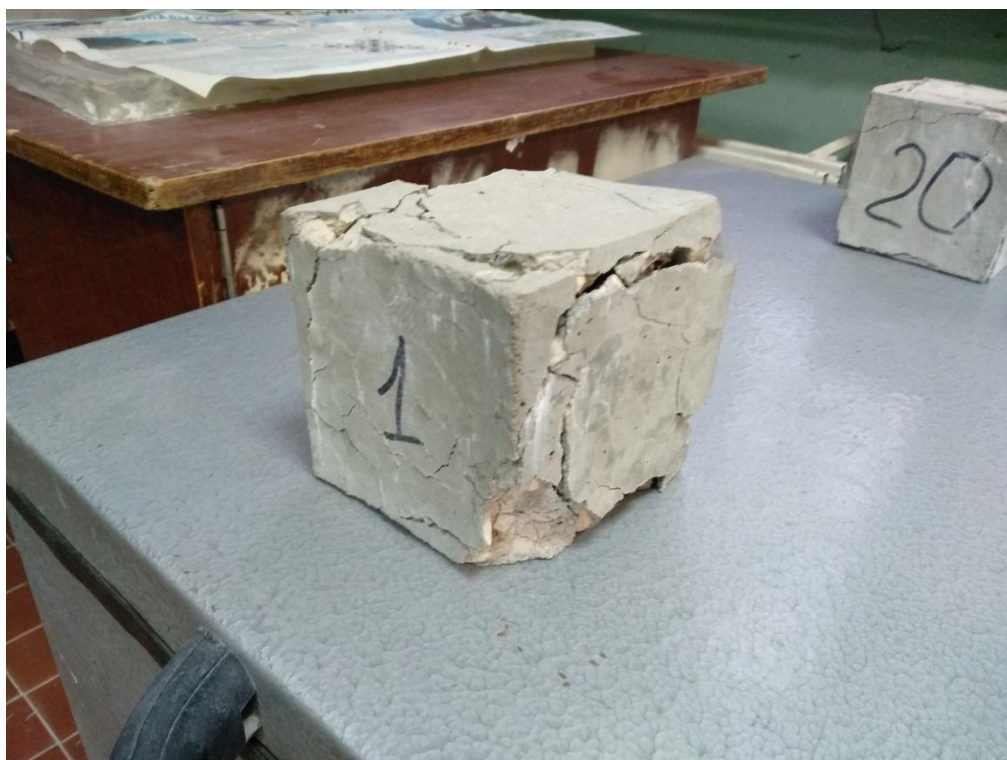
Рисунок Б.10 – Разрушение образца-куба после 14 циклов
