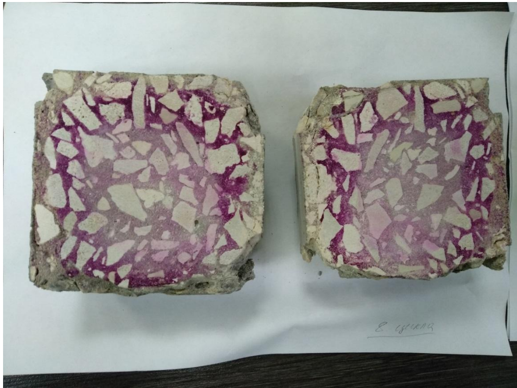
Рисунок Б.13 – Определение коррозии по образцам-кубам после 8 циклов
