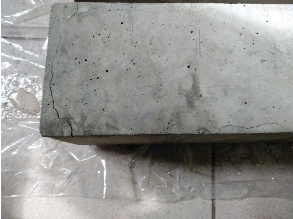
Рисунок В.3 – Образование трещин на образцах-призмах
