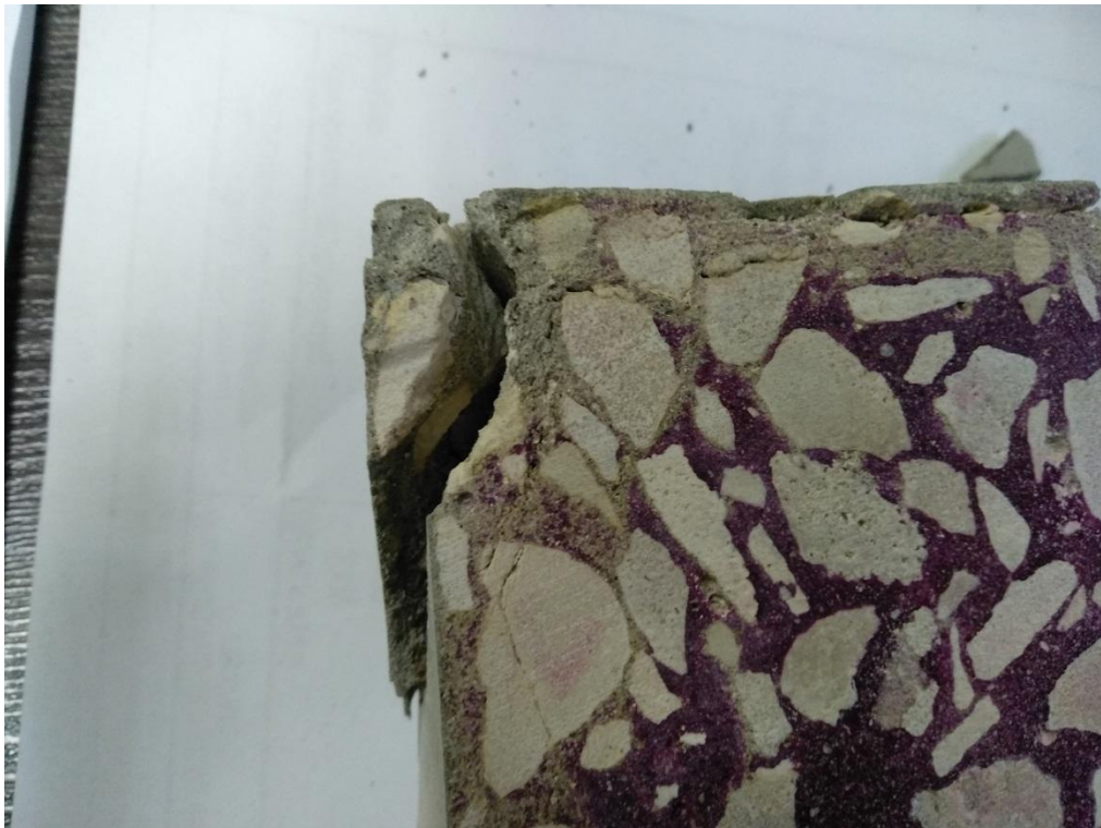
Рисунок Б.18 – Определение коррозии по образцам-кубам после 12 циклов
