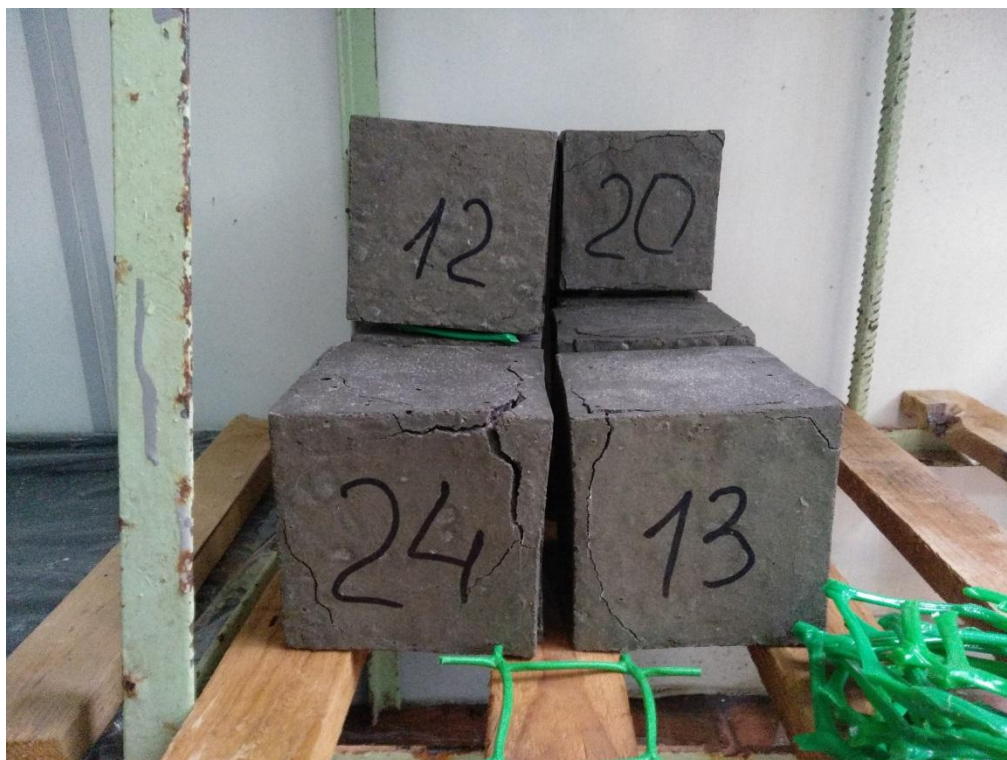
Рисунок Б.9 – Образование повреждений по образцам-кубам после 11 циклов
