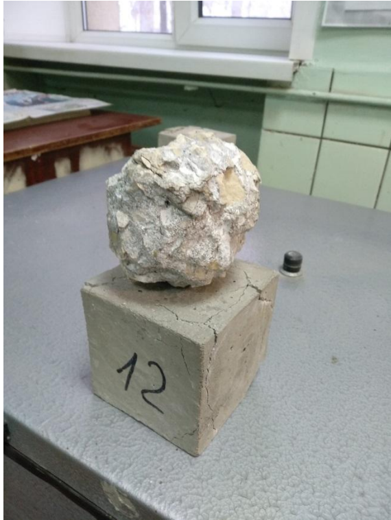
Рисунок Б.11 – Разрушение образца-куба после 14 циклов
