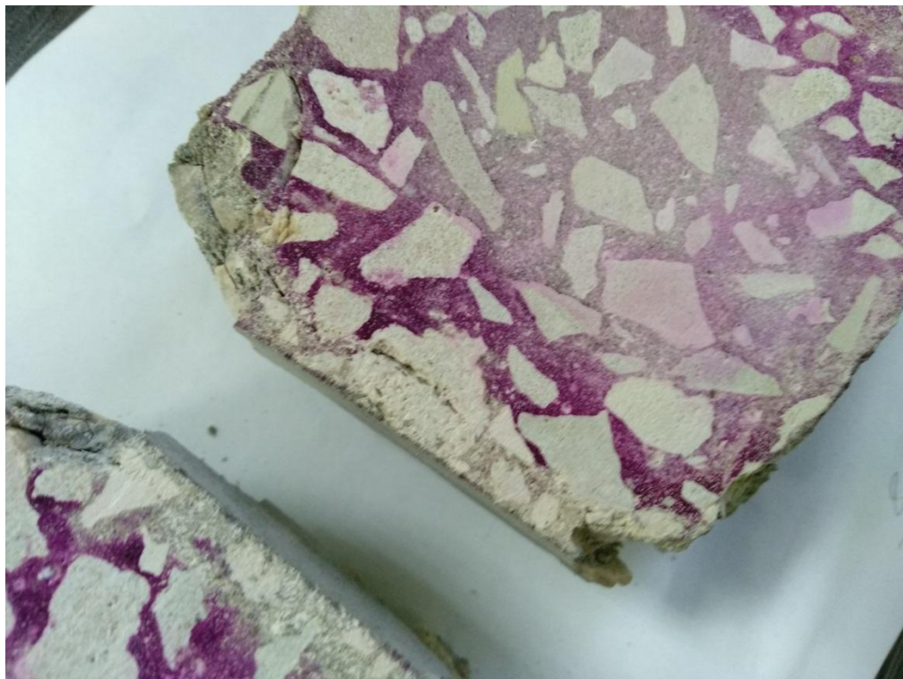
Рисунок Б.14 – Определение коррозии по образцам-кубам после 8 циклов
