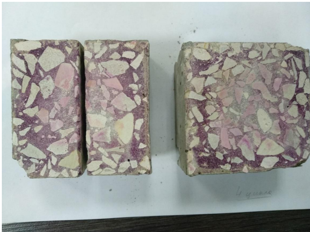
Рисунок Б.12 – Определение коррозии по образцам-кубам после 4 циклов
