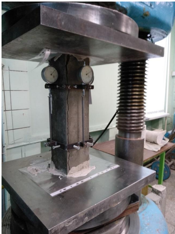
Рисунок В.10 – Испытание образца-призмы после 8 циклов воздействия
