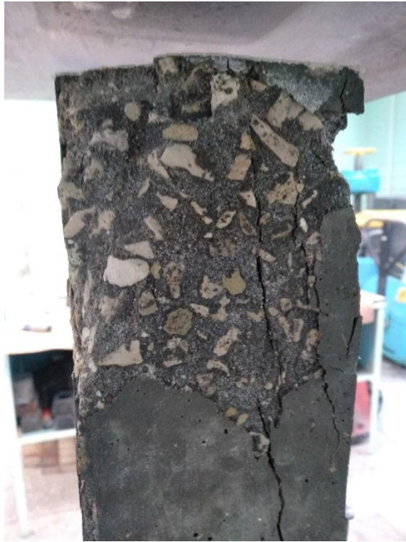
Рисунок В.9 – Испытание образца-призмы после 4 циклов воздействия
