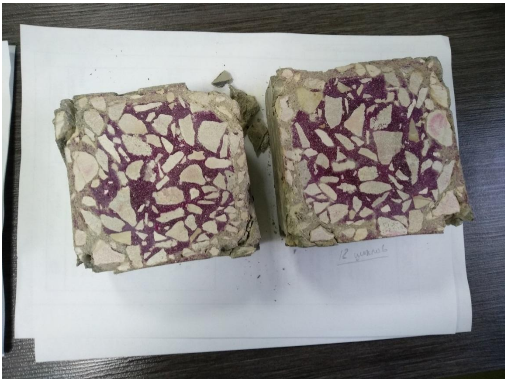
Рисунок Б.16 – Определение коррозии по образцам-кубам после 12 циклов
