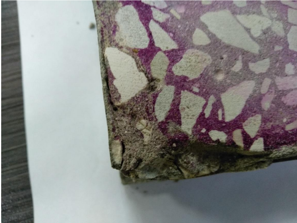
Рисунок Б.15 – Определение коррозии по образцам-кубам после 8 циклов
