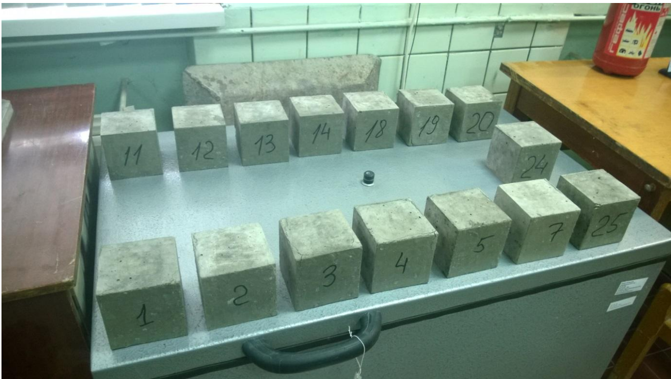
Рисунок Б.4 – Осмотр образцов-кубов после высушивания
