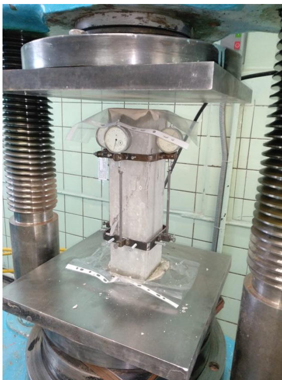
Рисунок В.5 – Испытание образца-призмы без агрессивного воздействия
