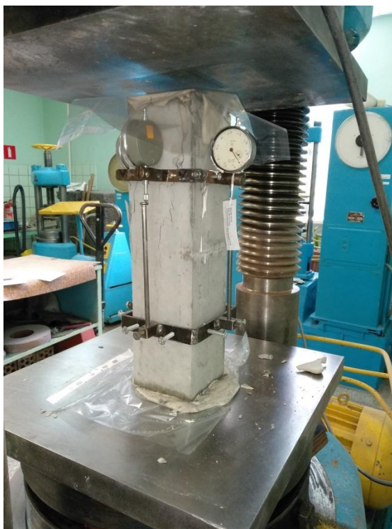
Рисунок В.6 – Испытание образца-призмы без агрессивного воздействия
