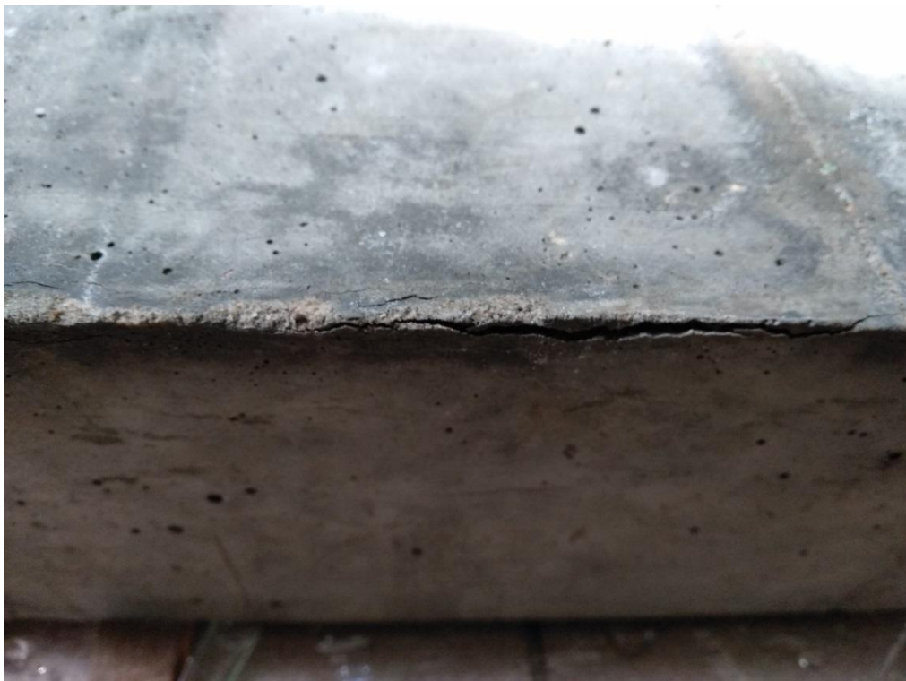
Рисунок В.4 – Образование дефектов на образцах-призмах
