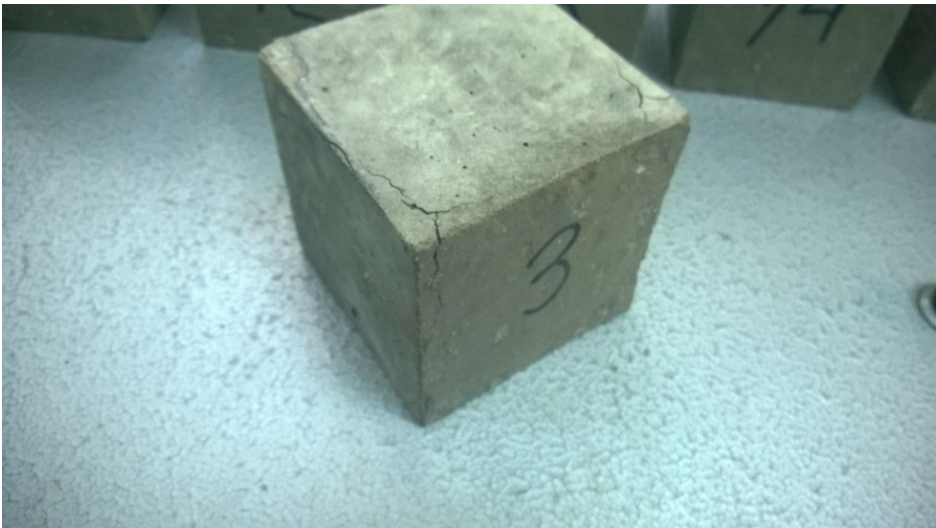
Рисунок Б.6 – Образование повреждений по образцам-кубам
