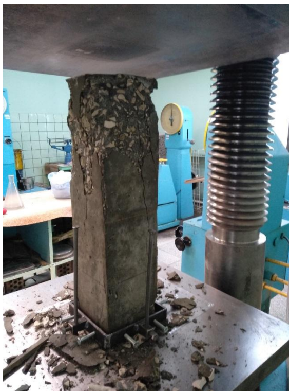
Рисунок В.8 – Испытание образца-призмы после 4 циклов воздействия
