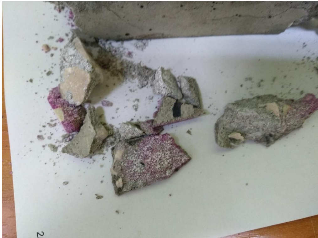
Рисунок Б.8 – Кристаллизация продуктов коррозии
