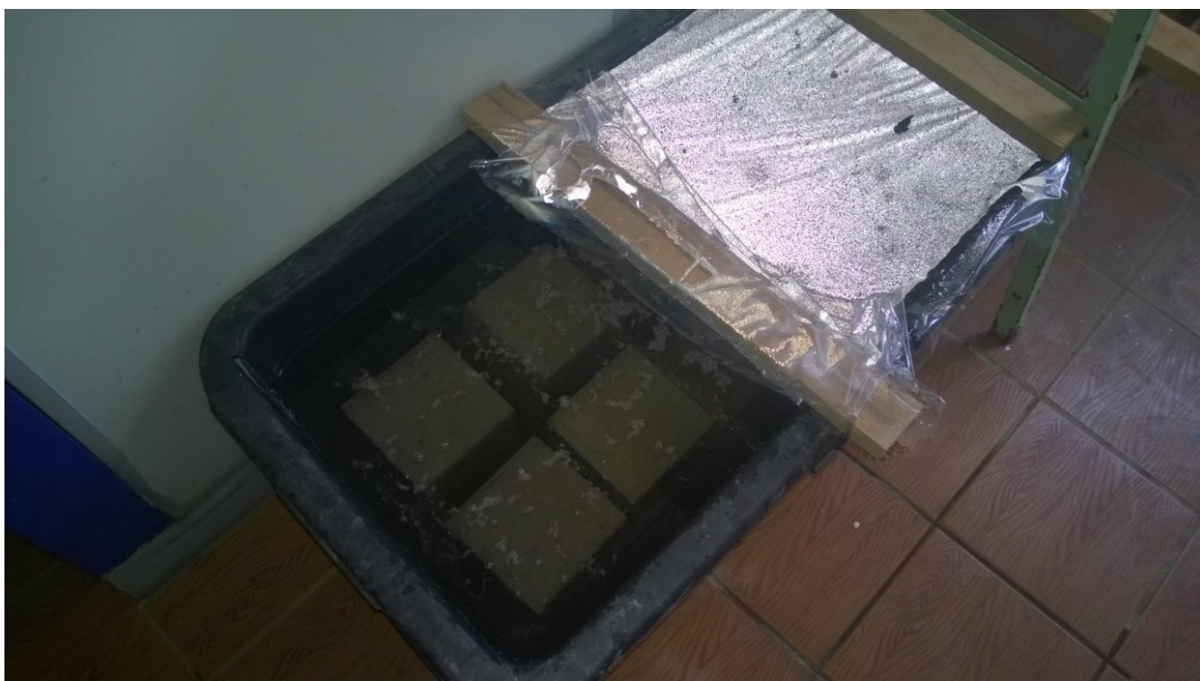
Рисунок Б.2 – Выдерживание образцов-кубов в агрессивной среде
