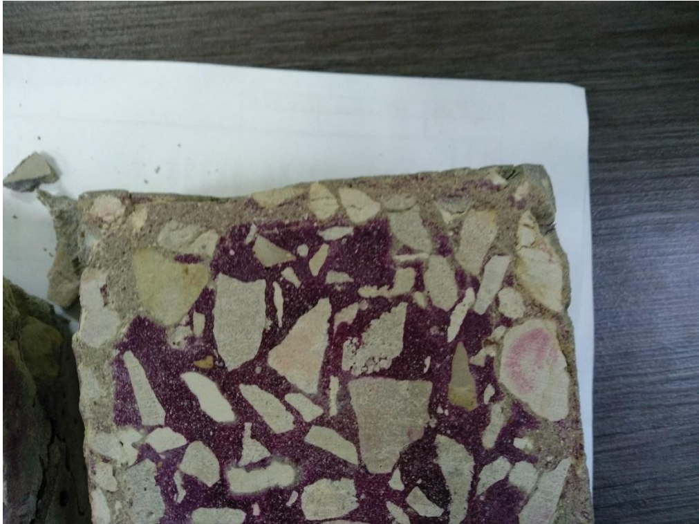
Рисунок Б.19 – Определение коррозии по образцам-кубам после 12 циклов
