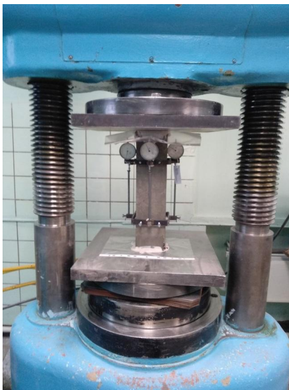
Рисунок В.7 – Испытание образца-призмы после 4 циклов воздействия
