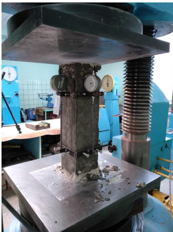
Рисунок В.11 – Испытание образца-призмы после 8 циклов воздействия
