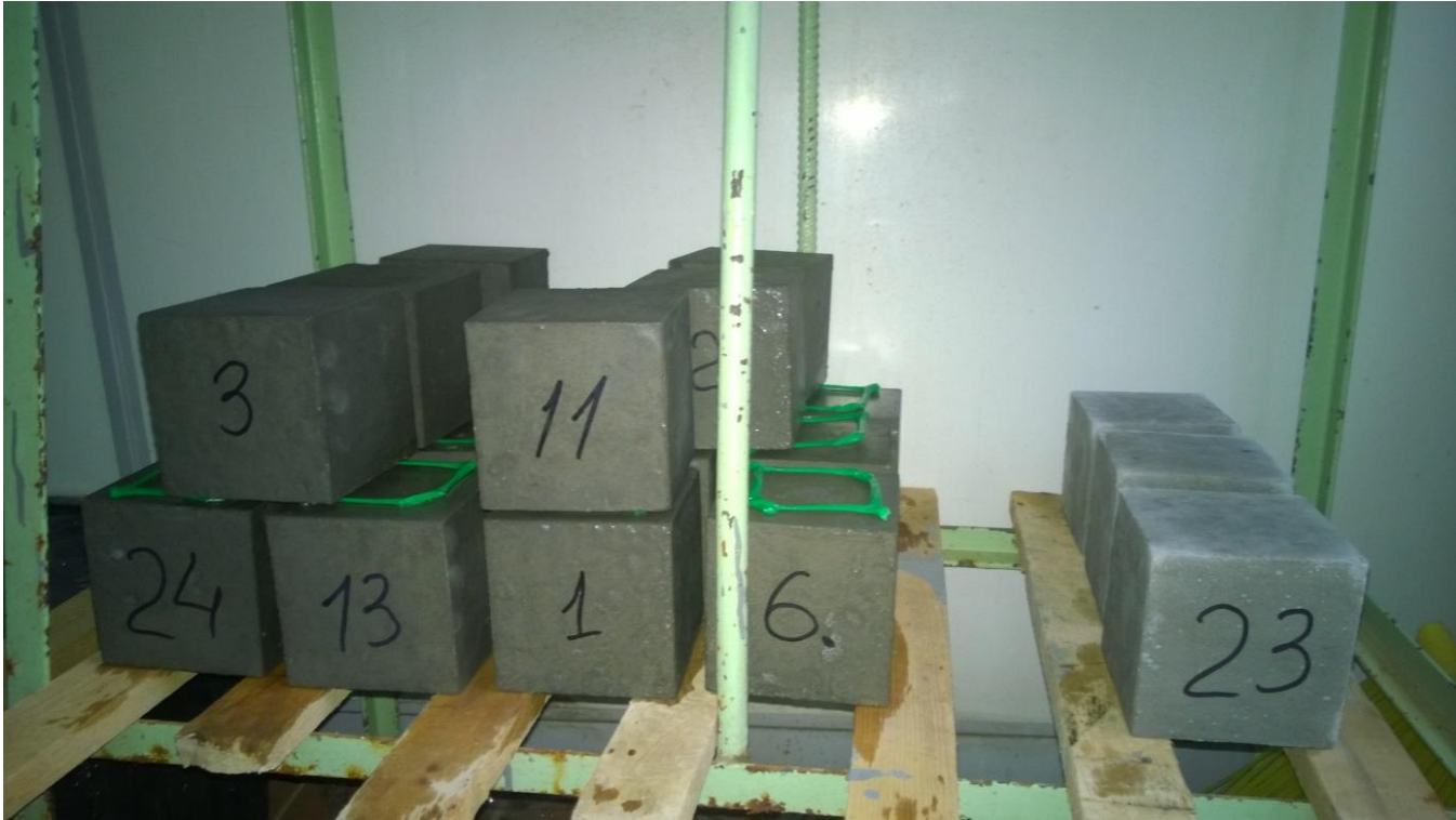
Рисунок Б.3 – Высушивание образцов-кубов после замачивания
