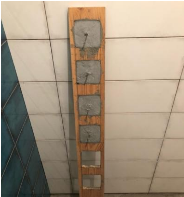
Рисунок 27 – Опалубка с изготовленными бетонными шляпками
