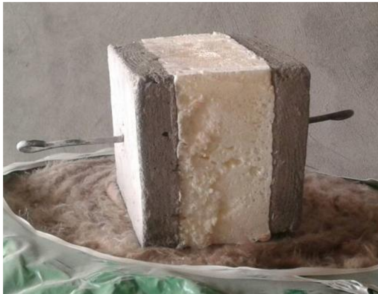
Рисунок 29 – Готовый образец габаритами 100x100x100
