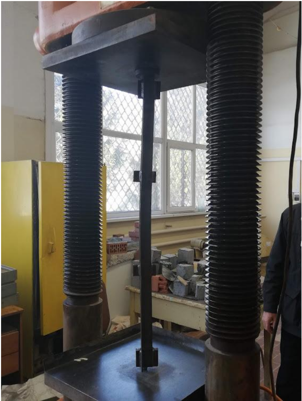
Рисунок 33 – Потерявший устойчивость стержень серии 1
