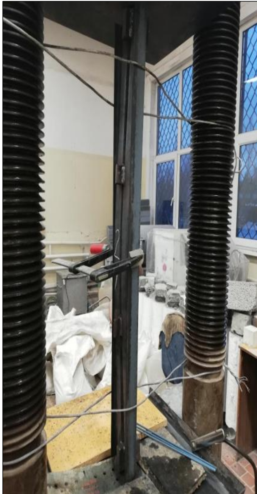
Рисунок 32 – Испытание стержня, усиленного длинными уголками
