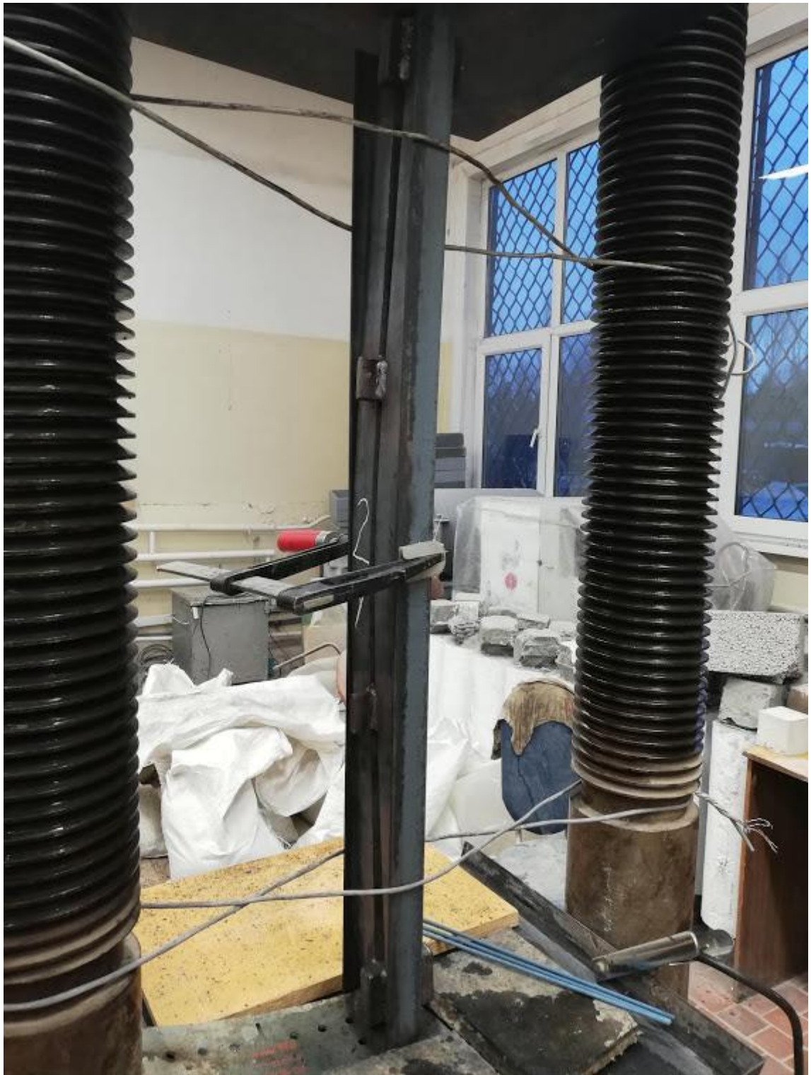
Рисунок 35 – Потерявший устойчивость стержень серии 2д
