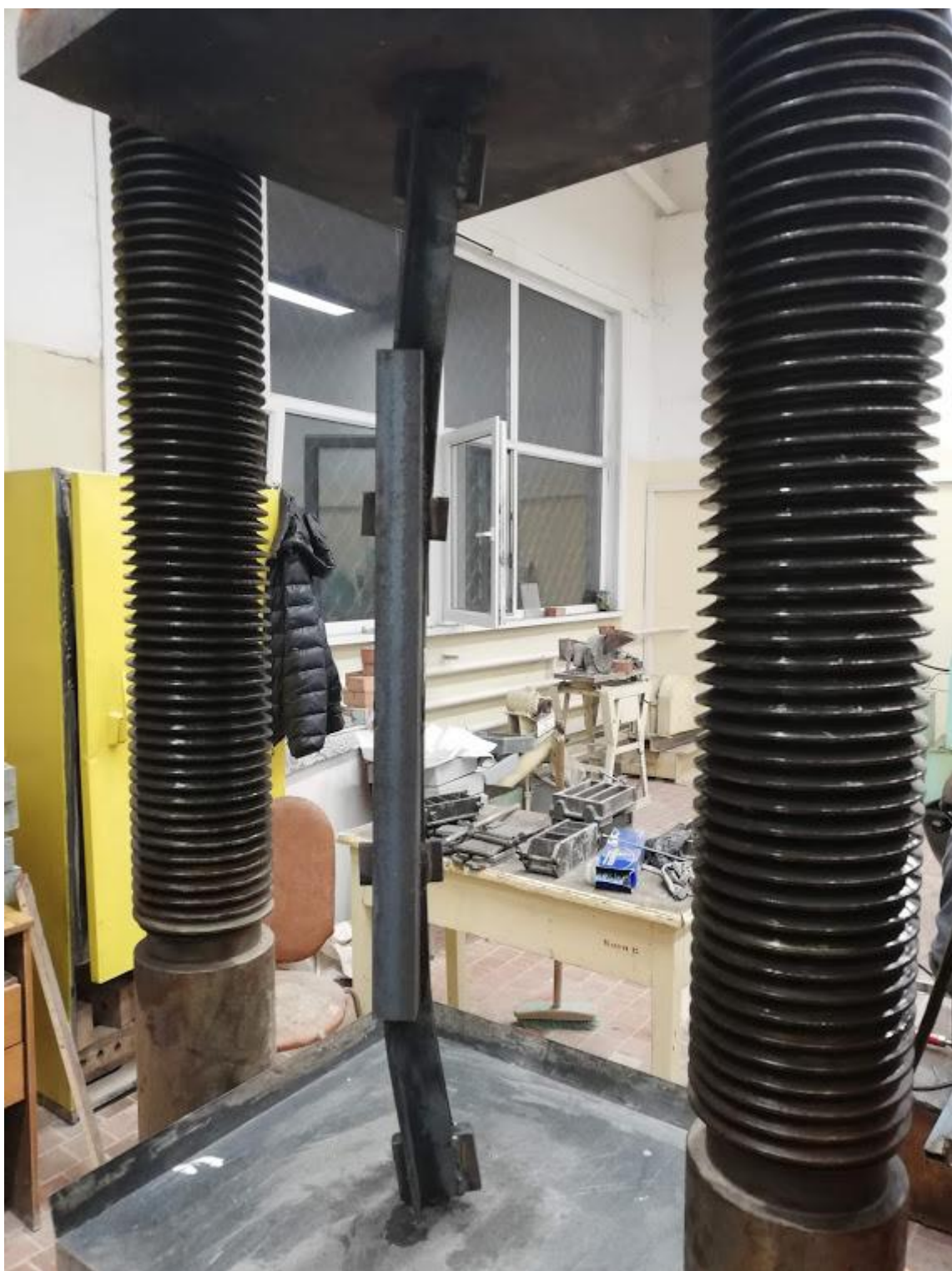
Рисунок 34 – Потерявший устойчивость стержень серии 2к
