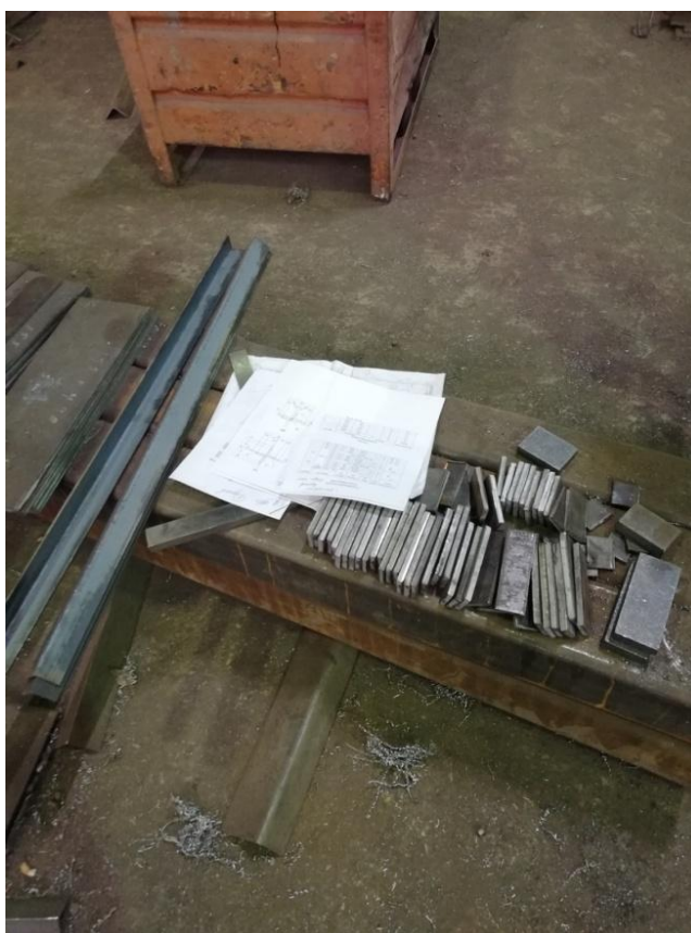
Рисунок 29 – Заготовки для изготовления экспериментальных стержней
