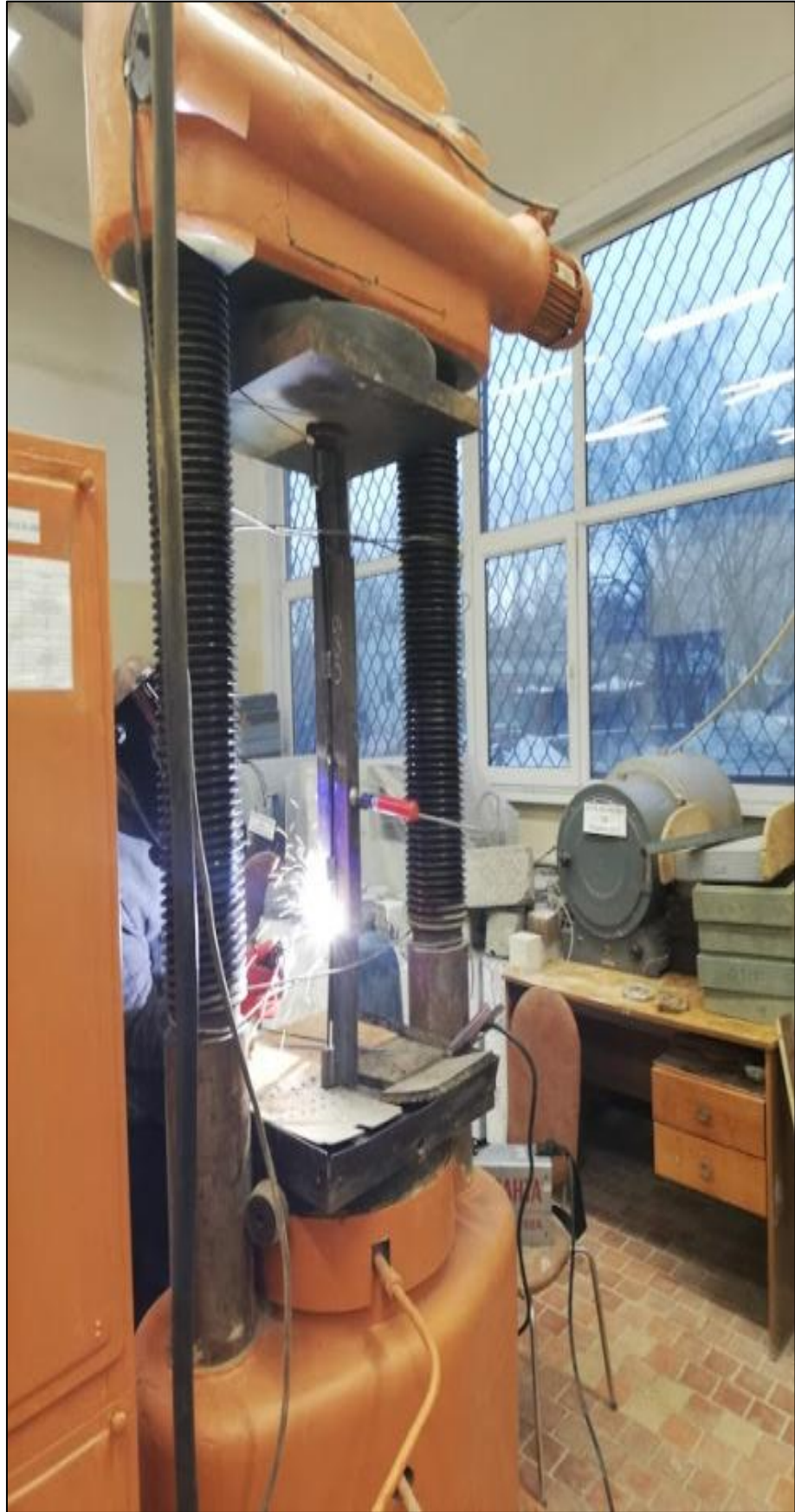
Рисунок 31 – Испытание стержня, усиленного короткими уголками
