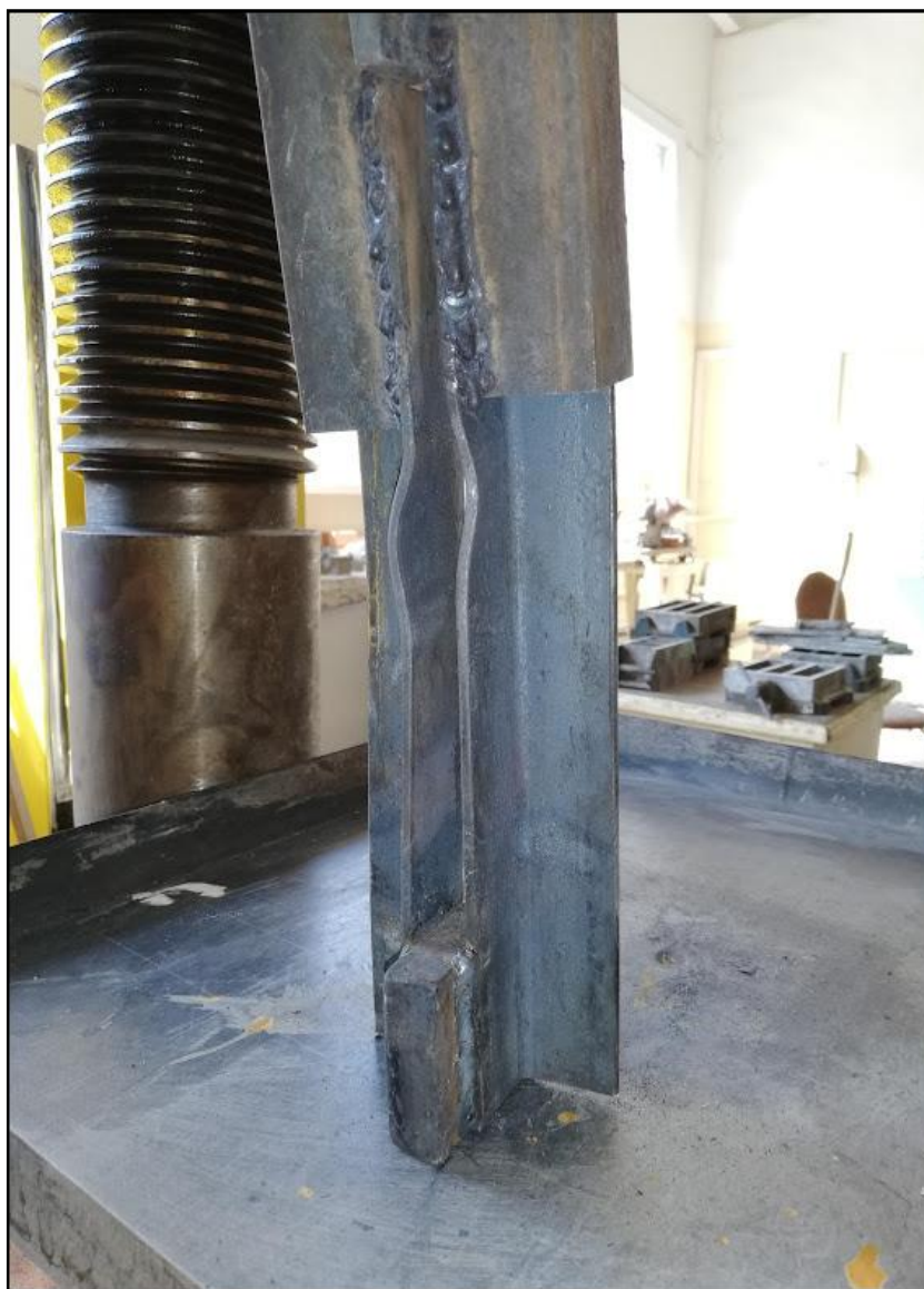
Рисунок 36 – Местная потеря устойчивости в приопорном участке стержня при усилении короткими уголками
