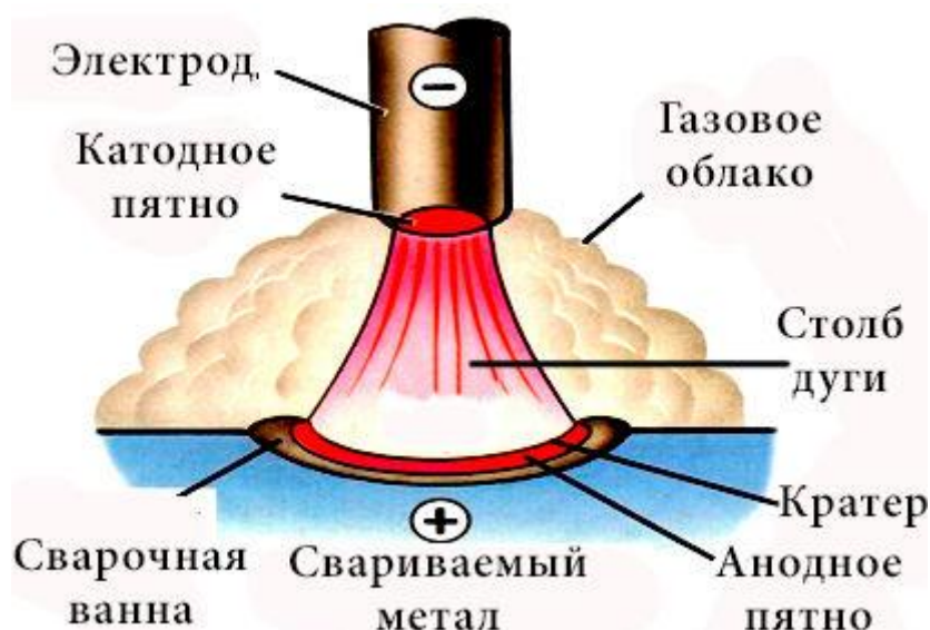
Рисунок 22 – Схема образования сварочной дуги
