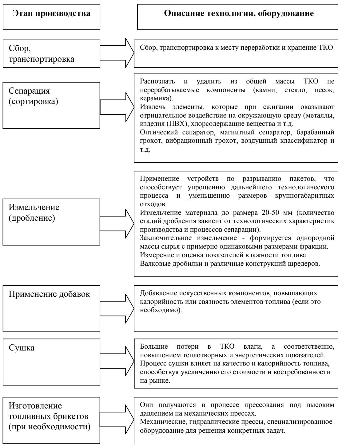
Рисунок 11 – Этапы производства альтернативного топлива
