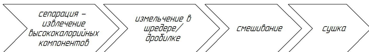
Рисунок 10 – Этапы обработки ТКО для получения RDF-топлива
