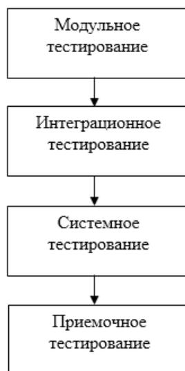
Рисунок 1.1 – Структурная схема процесса функционального тестирования ПО
