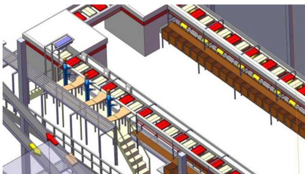
Рис. 3.10. Схема конвейера подачи коробок в зоне сортировки
