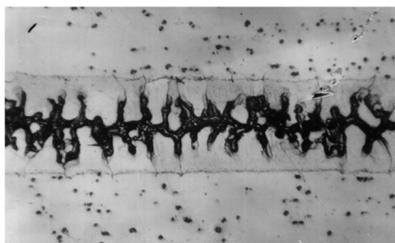
Рис. 5.7. Микроструктура паяного шва с дендритной текстурой (сплав ЭП718, припой ВПр7, зазор 0,15 мм)
