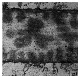
Рис. 5.8. Микроструктура паяного шва с дендритами у границ и внутри паяного шва (железо, припой – медь, зазор 0,3 мм)
