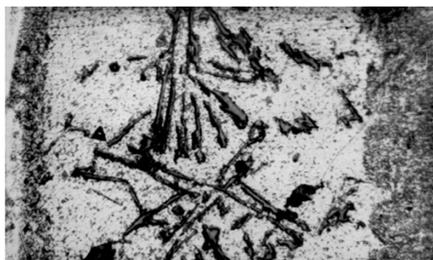
Рис. 5.16. Эвтектика Al – Si при пайке сплава АМц эвтектическим силумином
