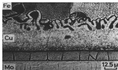
Рис. 5.25. Массоперенос в микроструктуре паяного шва Fe с Mo, припой – медь,  $T_{п} = 1120$  °C, время выдержки 5 мин
