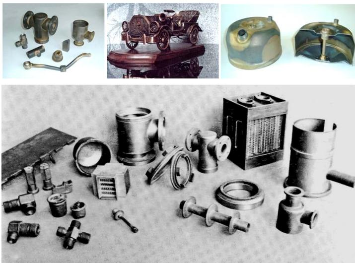
Рис. 2. Паяные конструкции
