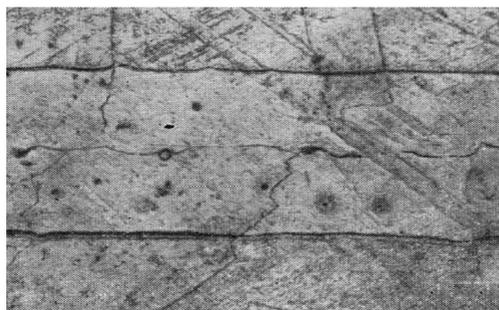
Рис. 5.13. Продолжение линий скольжения из зерен основного металла в зерна паяного шва (сталь X18H10T, припой Г40НХ, зазор 0,06 мм)
