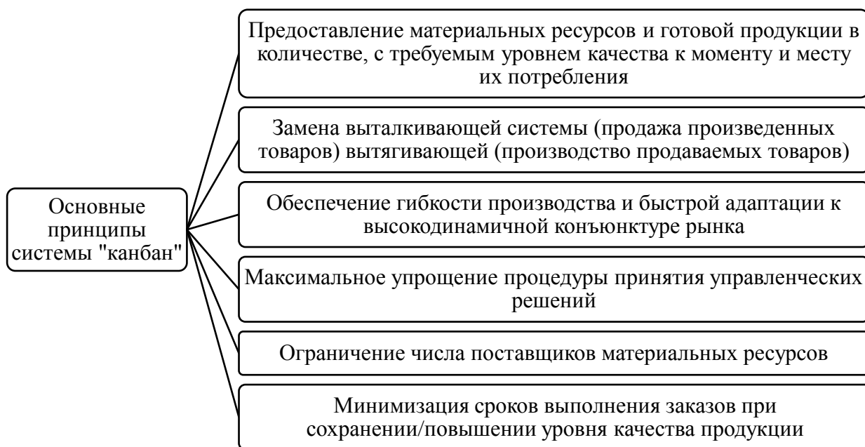
Рисунок 3.2 – Комплекс принципов системы «канбан»
