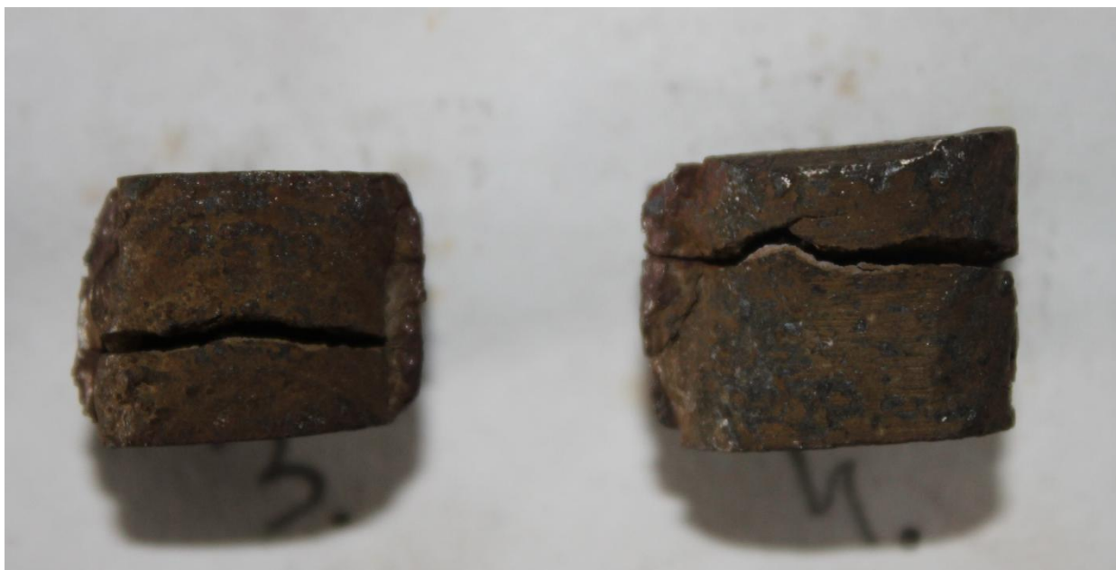
Рисунок 3.15 – Экспериментальные образцы по определению термостойкости в водяных теплосменах с образовавшимися дефектами.
