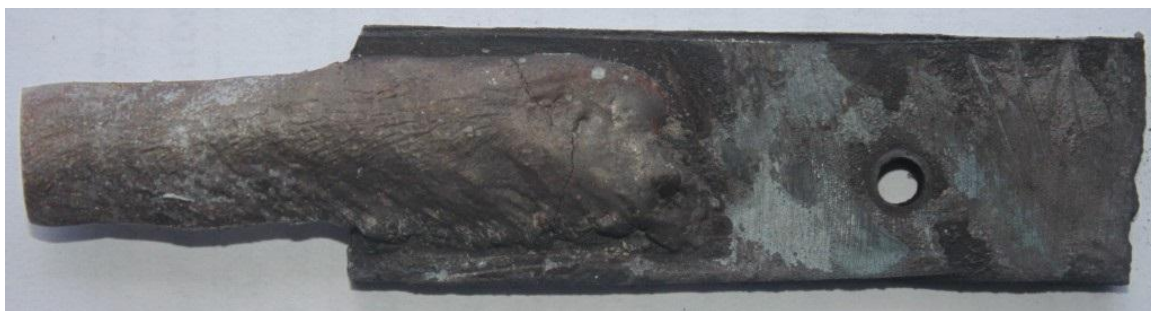
Рисунок 3.28 – Образец с интерметаллидным покрытием системы железо-алюминий после проведения эрозионных испытаний
