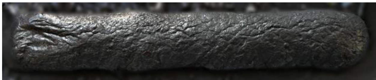
Рисунок 3.22 – Наплавленное покрытие системы Fe-Al №13
