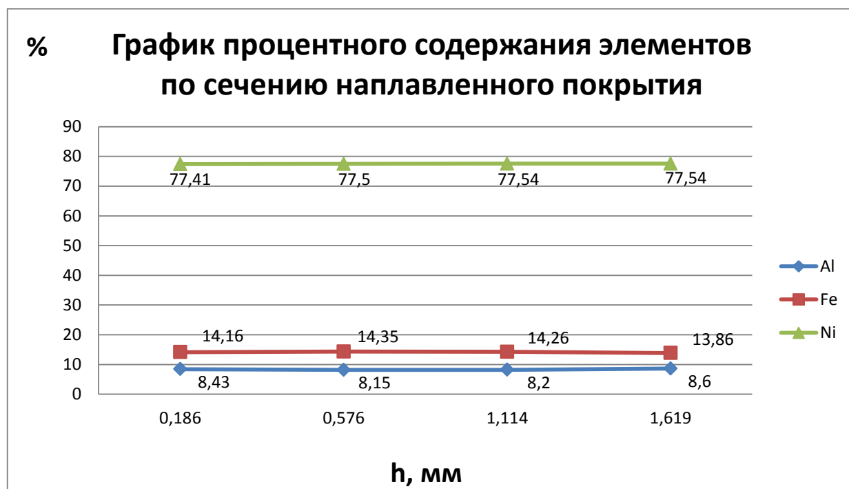
Рисунок 3.3 – Распределение химических элементов по сечению наплавленного образца №1
