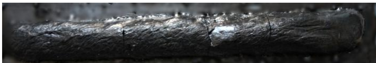
Рисунок 3.30 – Наплавленный валик с наблюдаемыми трещинами и отслоением металла
