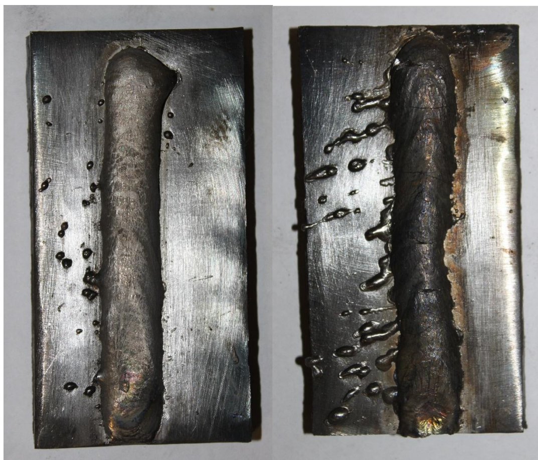
Рисунок 3.33 – Внешний вид наплавленных валиков
