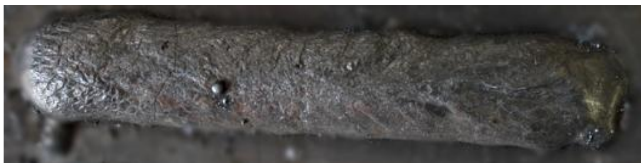
Рисунок 3.1 – Форма наплавленного покрытия №8
