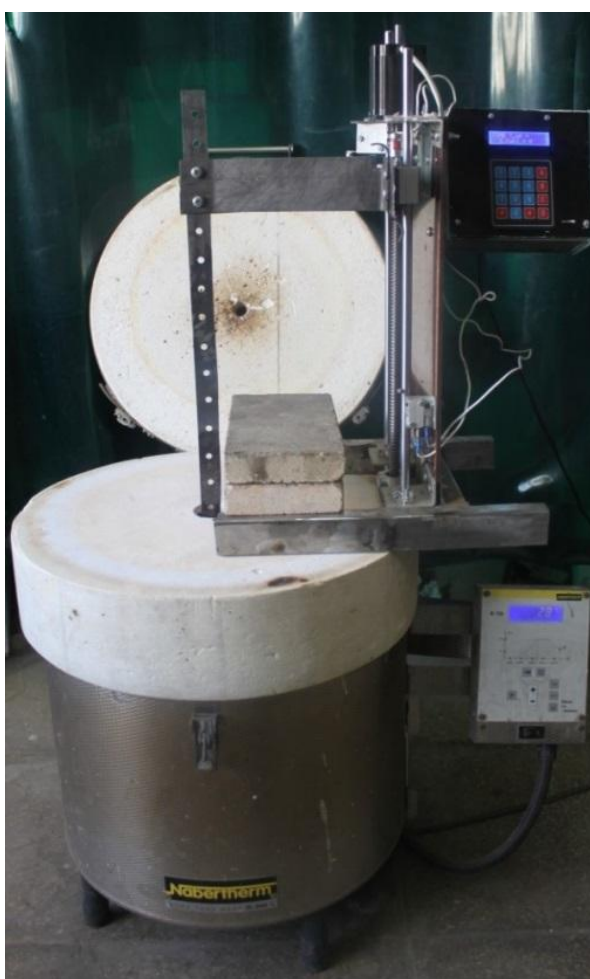
Рисунок 2.12 – Фотография автоматической установки для испытания эрозионной стойкости наплавленных покрытий
