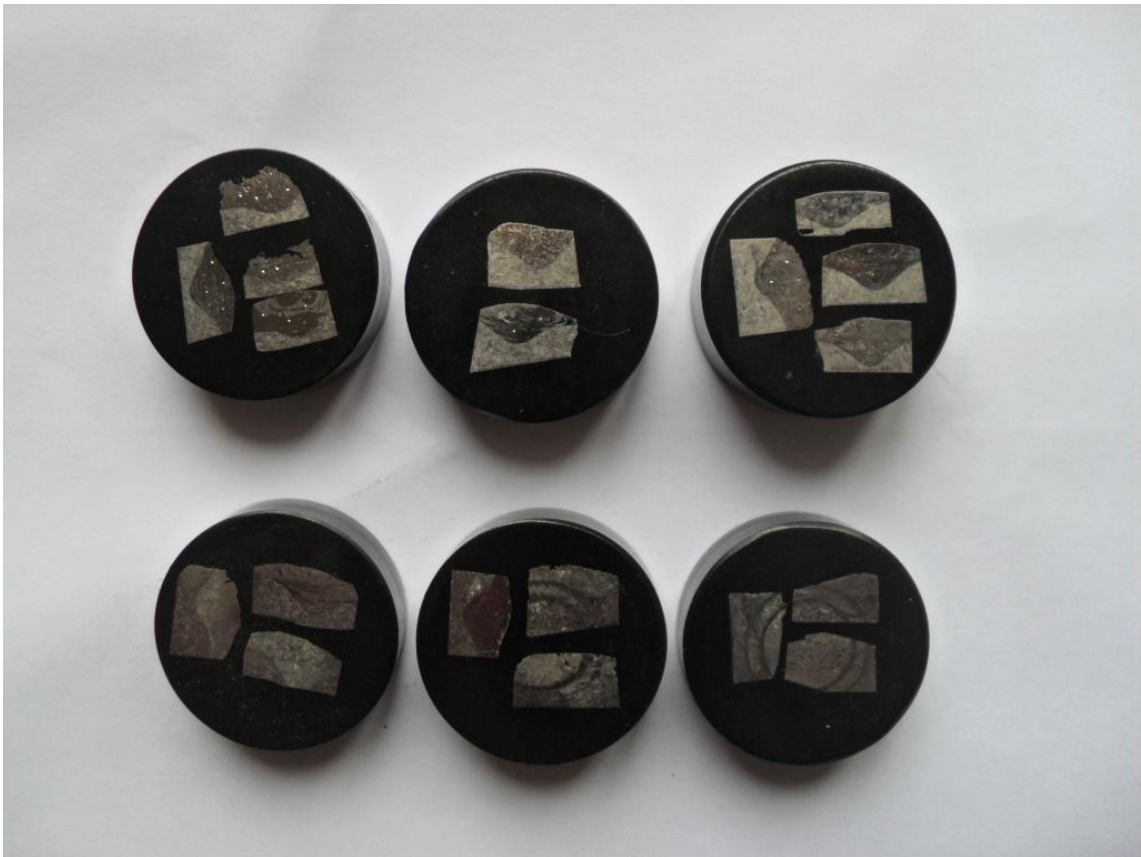
Рисунок 2.7 – микрошлифы наплавленных покрытий
