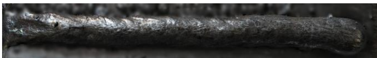
Рисунок 3.20 – Наплавленное покрытие системы Fe-Al №17
