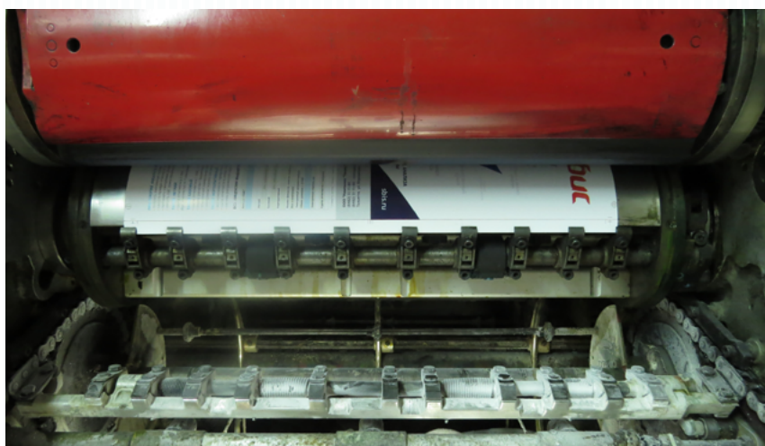
Рис. 6.6. Лист бумаги, проходящий между офсетным и печатным цилиндрами
