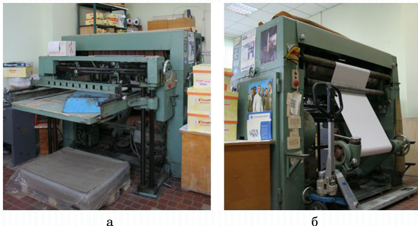
Рис. 2.1. Машина для размотки рулонной бумаги и резки ее на листы: а – вид слева; б – вид справа
