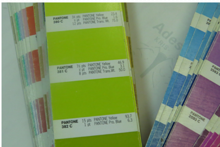
Рис. 9.2. Красочный каталог PANTONE SOLID. Видна рецептура приготовления конкретного оттенка
