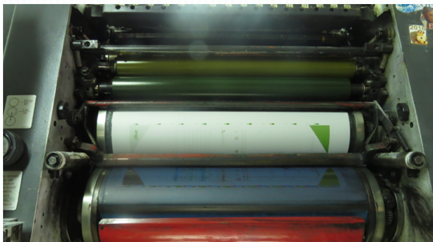
Рис. 6.5. Печатная секция. Формный и офсетный цилиндры
