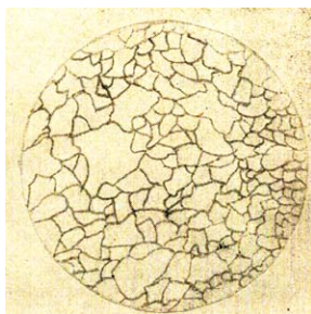
Рис. 4.3. Микроструктура стали со смешанным зерном № 3–6
