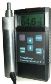
Рис. 10.10. Твердомер ультразвуковой NOVOTEST T-Y1. Измеряет твердость металлов и сплавов по шкалам твердости: Роквелла (20–70 HRC); Бринелля (90–450 HB); Виккерса (230–940 HV)
