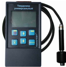
Рис. 10.11. Твердомер динамический NOVOTEST T-D2. Измеряет твердость металлов и сплавов по шкалам твердости: Роквелла (20–70 HRC); Бринелля (90–450 HB); Виккерса (230–940 HV)
