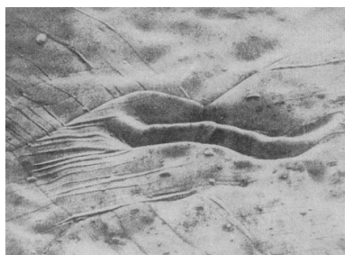
Рис. 13.1. Экструзии (выпуклости) и интрузии (впадины) в отожженном никеле (увеличение в 3600 раз)
