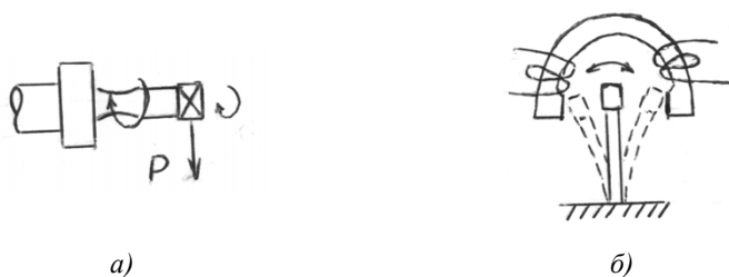
Рис. 13.8. Нагружение образцов: а – мягкое; б – жесткое
