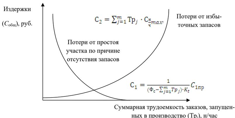
Рис. 7.8. Оптимизация размера буфера запасов
