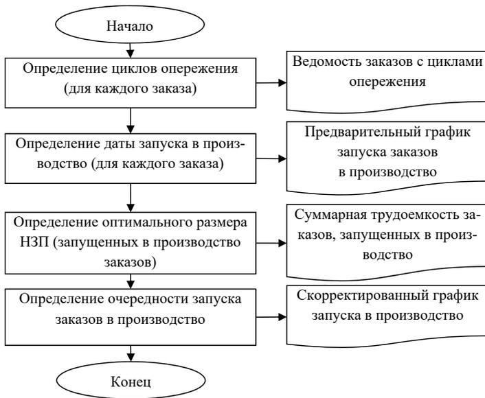
Рис. 7.6. Методика определения размера буферного запаса узкого места
