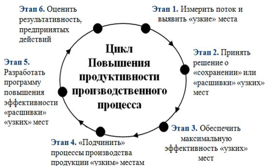
Рис. 7.1. основополагающий цикл оперативного управления производственным процессом
