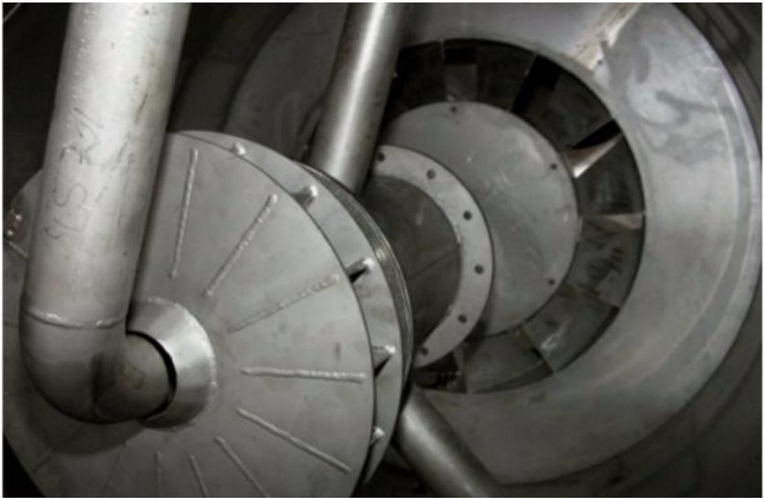
Рисунок 14 – Внутреннее устройство ротационного скруббера
