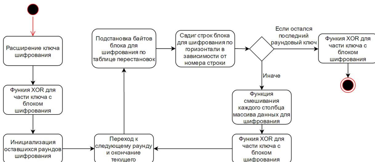
Рисунок 2.4 – Алгоритм шифрования AES
