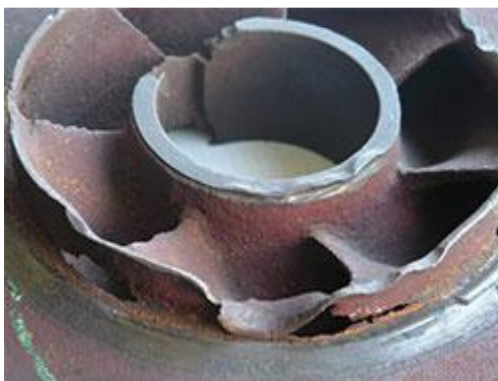
Рисунок 1- Разрушенное рабочее колесо насос. Последствие кавитации.
